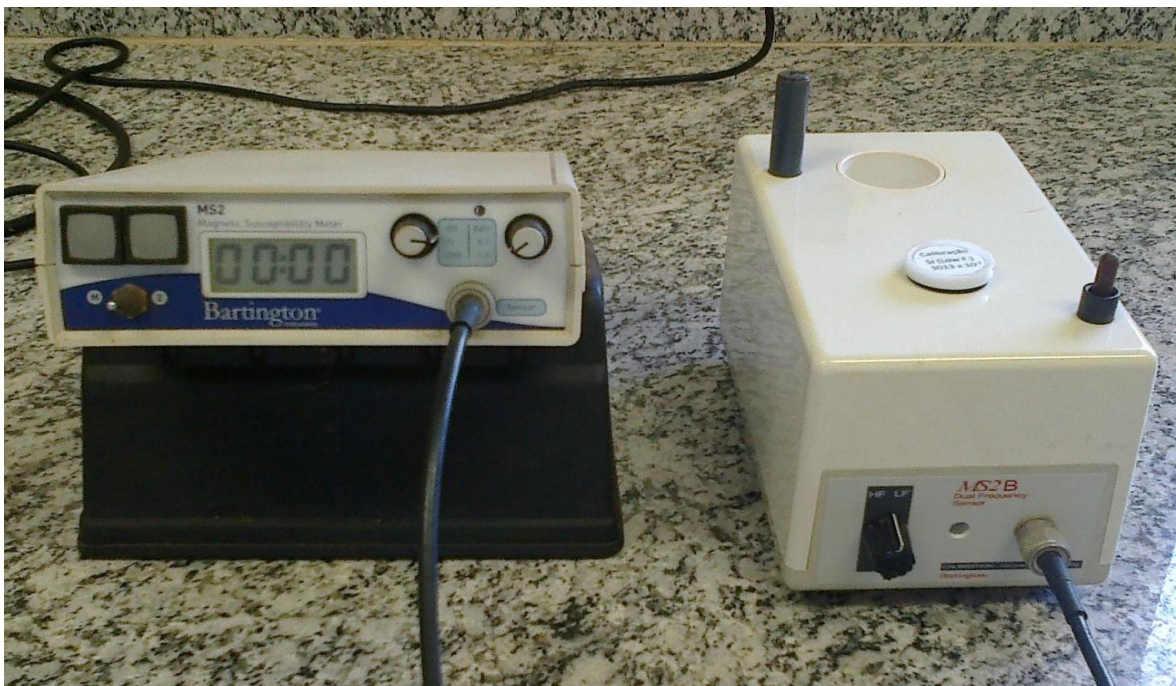
Figura 3 - Medidor de suscetibilidade magnética Bartington MS2 com um sensor de leitura em laboratório MS2B.
