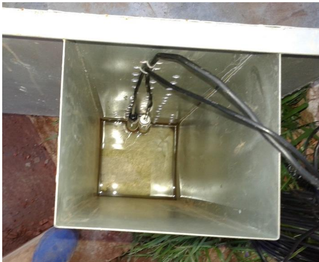
Figura 25 - Monitoramento da descarga líquida. Linígrafo.
