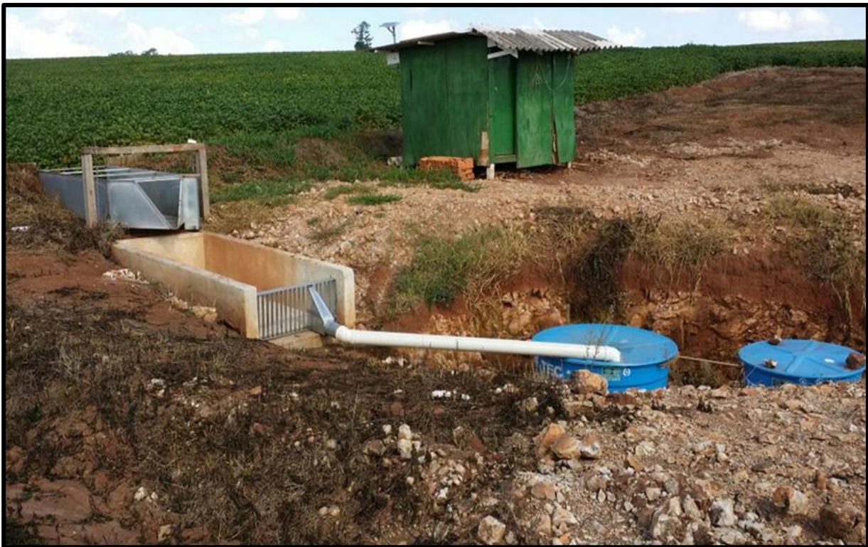
Estação de monitoramento indicando a calha, vertedouro, canal, divisores Geib e caixas de acúmulo.
