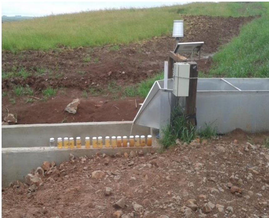
Figura 28 - Monitoramento da CSS. Amostras coletadas.
