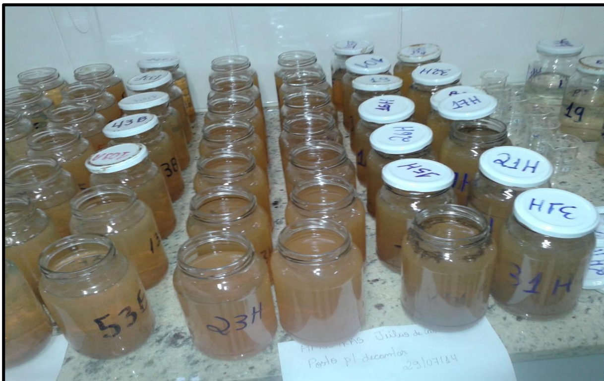
Amostras em Decantação para análise de CSS.i
