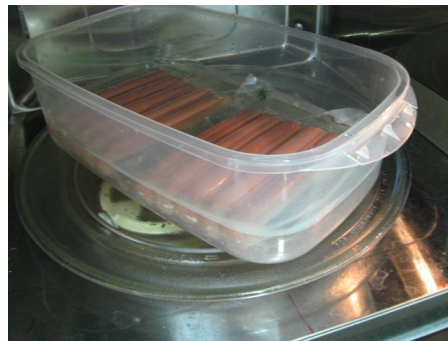
Figura 3.3 - disposição das embalagens dentro do forno de micro-ondas para os tratamentos em banho-maria.
