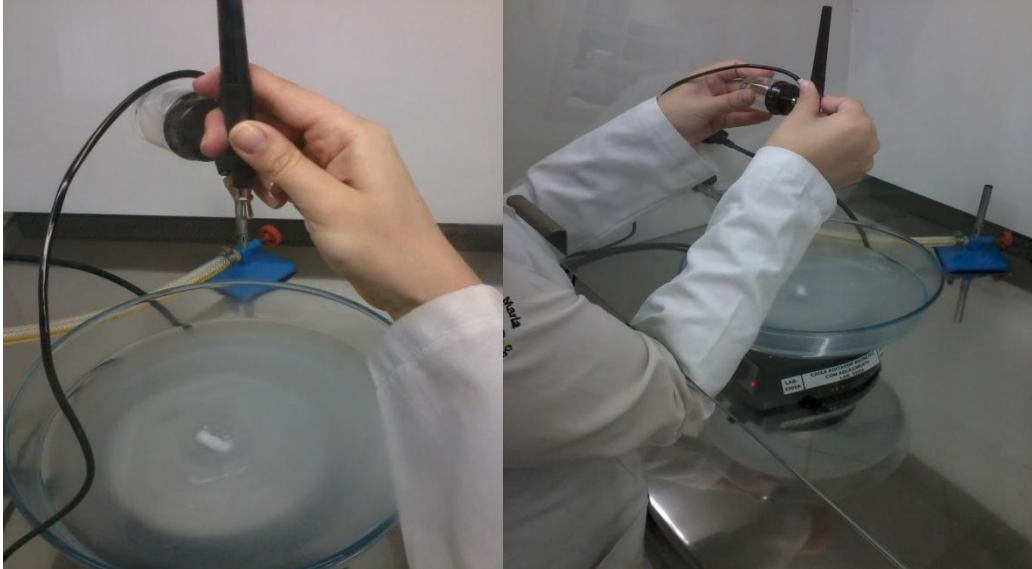
Figura 11 – Testes preliminares para testar a distância ideal entre o aerógrafo e a solução iônica.
