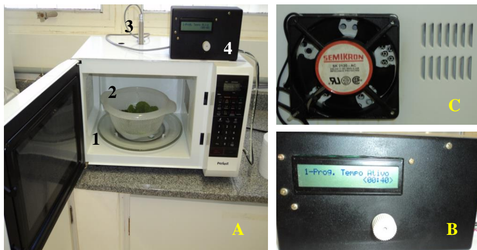
Figura 8: Forno MO adaptado utilizado no experimento. A: Vista geral do equipamento; 1: parte interna da cavidade, 2: recipiente com a amostra, 3: pirômetro óptico (sensor infravermelho) para monitoramento e controle da temperatura superficial, 4: Vista geral do sistema de controle microprocessado para ajuste de variáveis de secagem B: Vista aproximada do sistema de controle microprocessado para ajuste das variáveis (tempo, temperatura, variação de temperatura, emissividade, rampa de aquecimento e tempo de resfriamento). C: Exaustor para resfriamento do sistema, localizado na lateral esquerda do equipamento.
