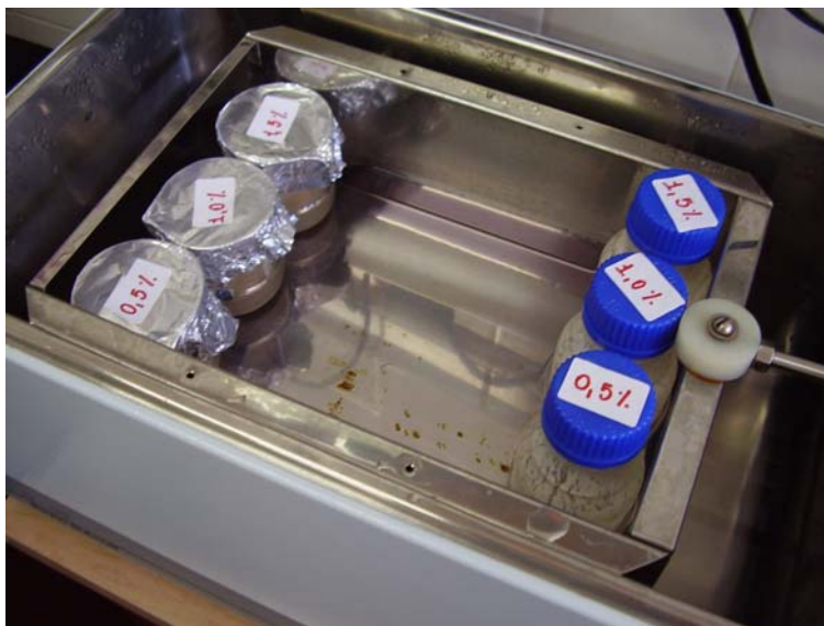
Figura 6 - Amostras de iogurtes (porções) no banho termostático à 40°C, para determinação do valor de pH e acidez durante o processo de fermentação.
