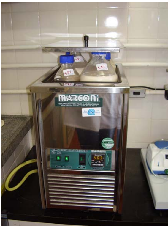
Figura 5 - Amostras de iogurte no banho termostático à 40°C.
