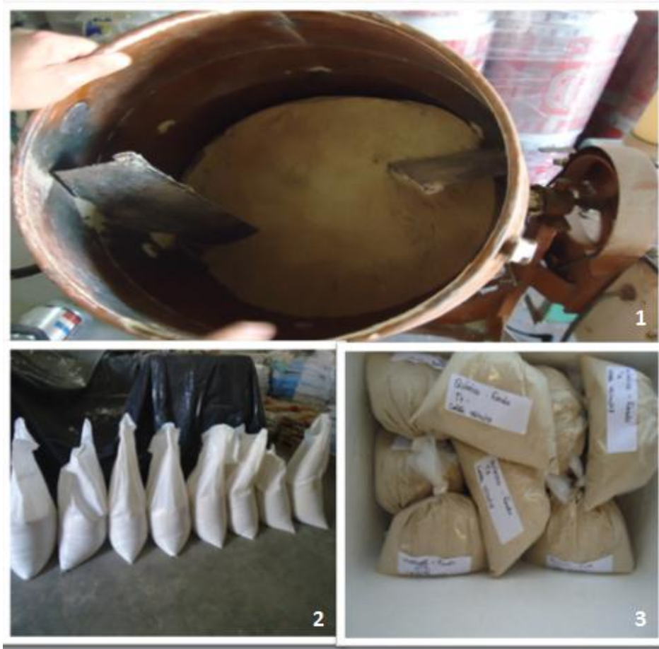
Figura 7 – Aplicação dos antioxidantes; 1) Demonstração da mistura do FAI e antioxidantes; 2) FAI tratado de acordo com cada tratamento e embalado em sacos de ráfia; 3) Amostras para análise coletadas após aplicação dos antioxidantes. (Fotos: do autor)
