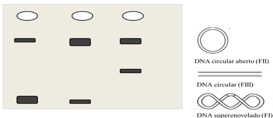
Figura 7 – Representação da clivagem do DNA pela transformação da forma superenovelada (FI) nas formas circular (FII) e linear (FIII) via eletroforese em gel de agarose.
