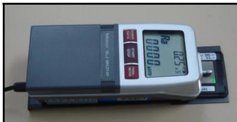
Figura 6: Rugosímetro Mitutoyo Surftest SJ-201P
