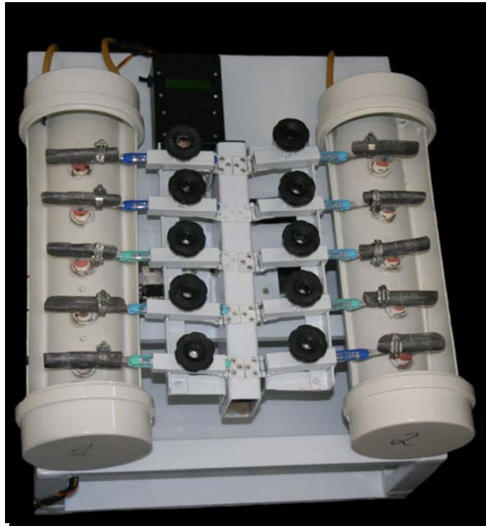
Figura 7: Máquina de escovação mecânica
