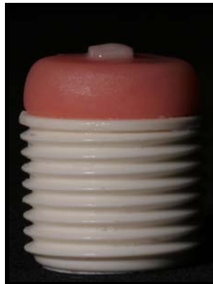
Figura 8: Fixação dos espécimes na base de resina acrílica
