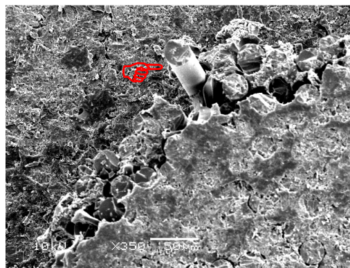
Figura 11B- Imagem aproximada evidenciando separação nítida entre as fibras e a matriz do pino. Seta indica uma fibra totalmente separada da matriz.
