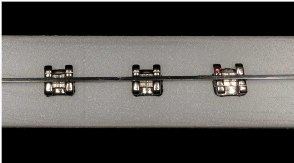
Figura 2 – Corpos de prova prontos para os ensaios mecânicos de tração.
