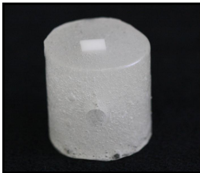
Figura 6 – Bloco de Y-TZP embutido em resina acrílica
