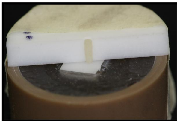
Figura 9 – Cimentação no teste de microcisalhamento
