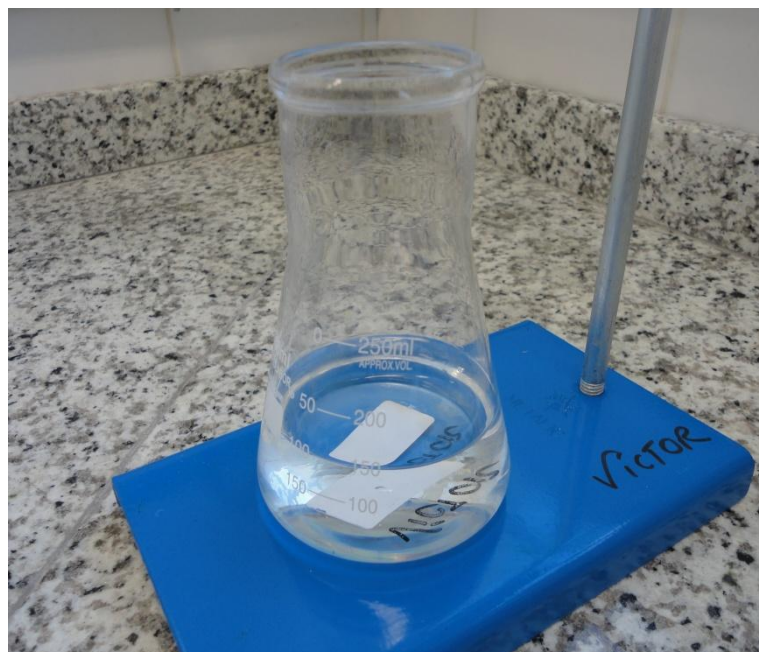
Figura 9. Solução límpida após titulação com tiosulfato de sódio
