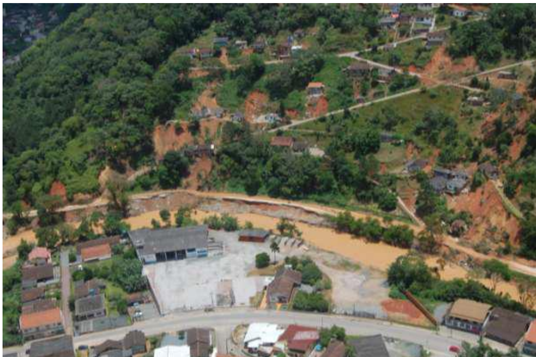
Figura 7 - Deslizamento em área de risco ocupada no Bairro Progresso em Blumenau-SC. (Foto: Eraldo Schneider – 30.11.2008). Fonte: MINISTÉRIO DO MEIO AMBIENTE, 2011.
