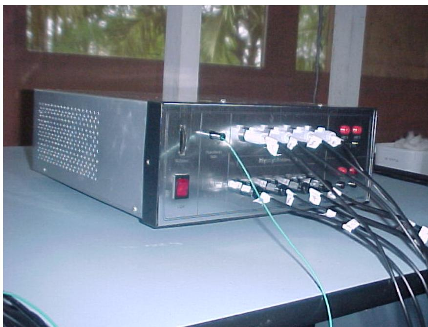
**Figura 06** - Eletromiógrafo.
