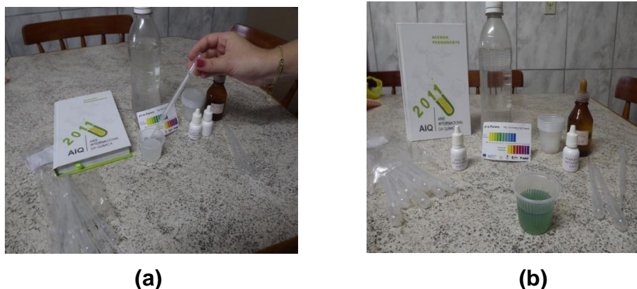
Figura 5 - (a) Análise qualitativa de íons cloreto e (b) Determinação do pH na água do mar
