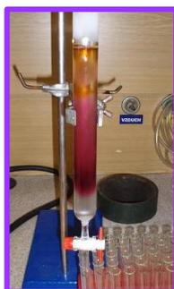
A cromatografia em coluna é um método de separação dos componentes de uma mistura que se baseia na diferença
