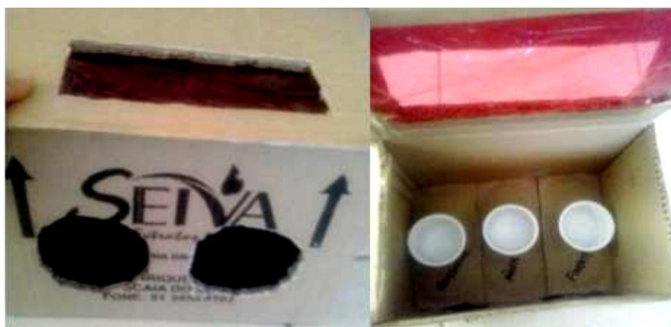
Figura 57 – Caixa “caseira” de processamento radiográfico
