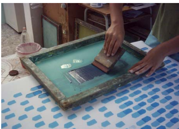
Figuras 32 e 33 - Processo de estampagem – Estampa Corrida. Fonte: Idem figura 09.
