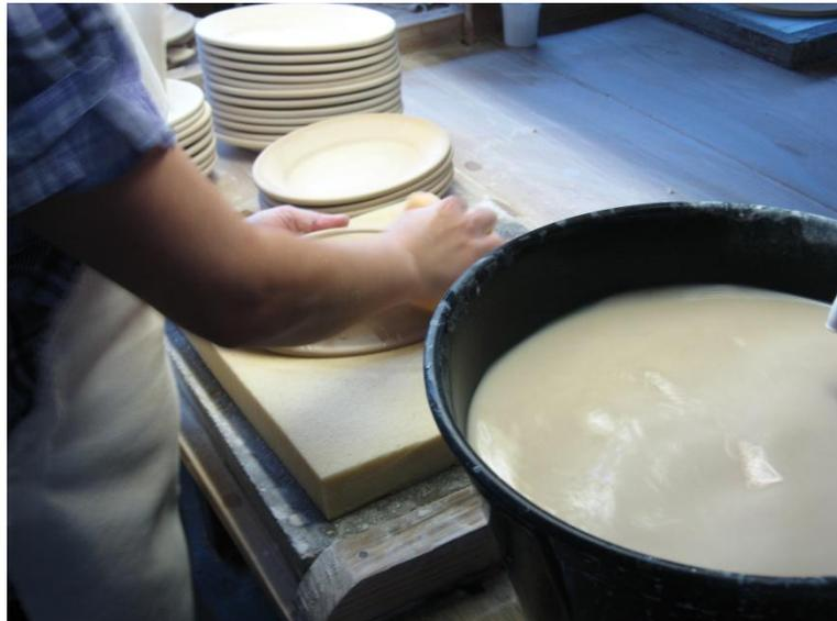
Figura 20 – Correção de imperfeições da peça.
