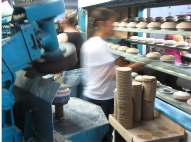
Figura 21 – Torno automático e secadora contínua.
