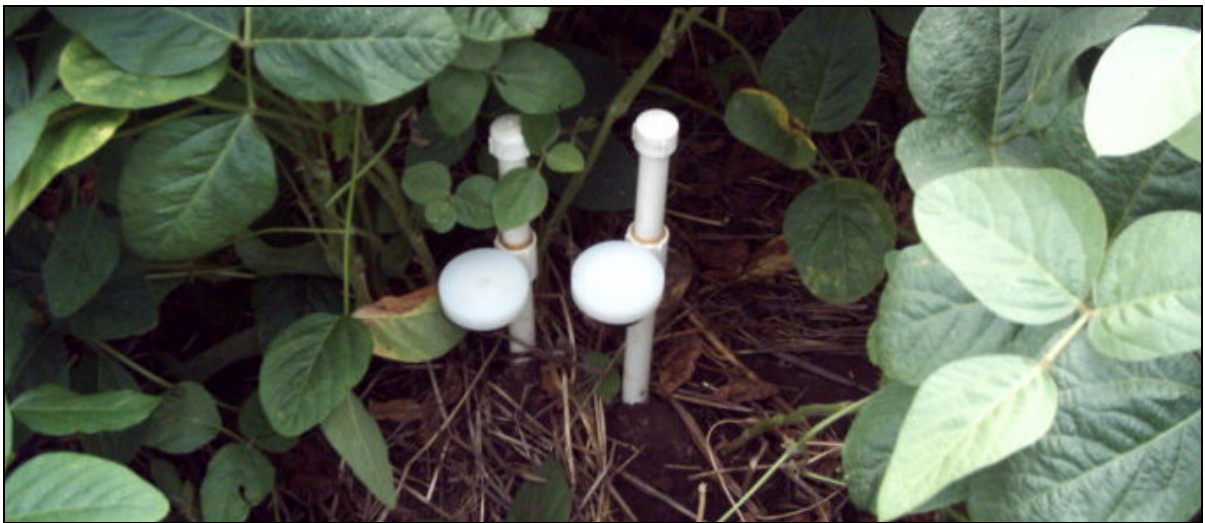
Figura 2. Tensiômetros de Bourdon instalados a 15 e 30 cm no solo do experimento para monitoramento da tensão de água no solo. 2005, Santa Maria, RS.
