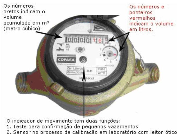
Figura 2.16 – Funções do mostrador de um hidrômetro.
