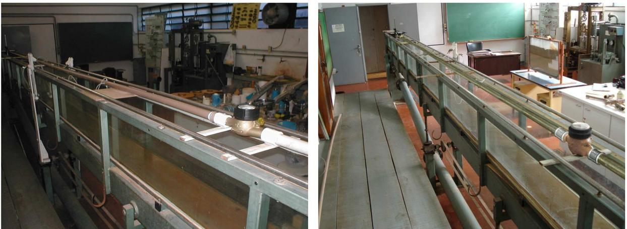
Figura 3.3 – Determinação da perda de carga linear: canos PVC e aço galvanizado.
