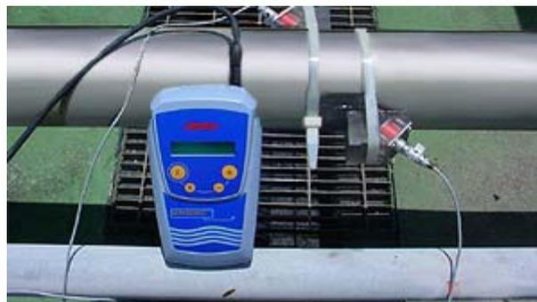
Figura 2.8 – Medidor ultra-sônico de vazão (portátil).
