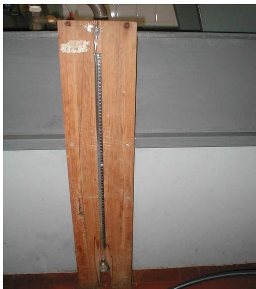
Figura 3.6 – Régua graduada utilizada na determinação do volume.
