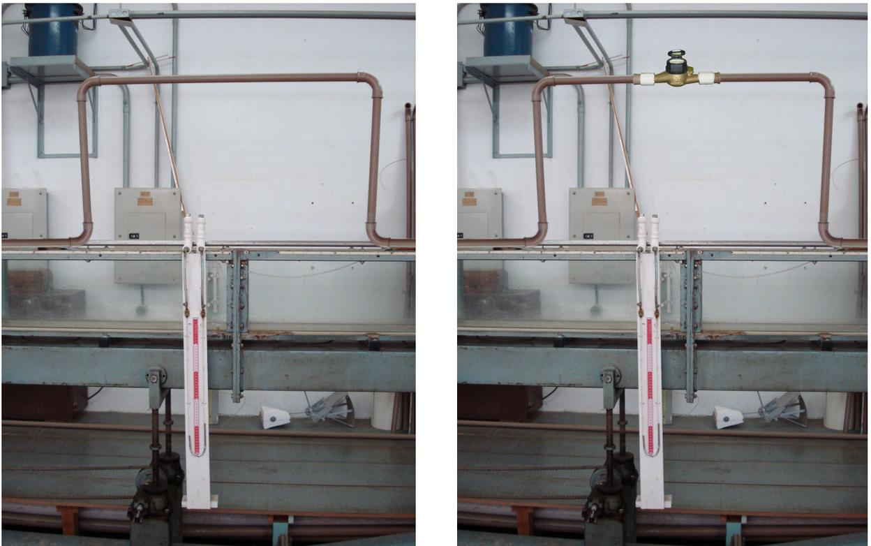
Figura 3.6 – Montagem para a determinação da perda de carga da estrutura sem hidrômetro e com hidrômetro.
