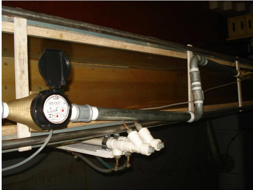
Figura 3.8 – Montagem para a determinação da perda de carga das peças da estrutura do medidor.
