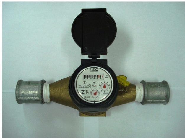
Figura 3.4 – Hidrômetro
