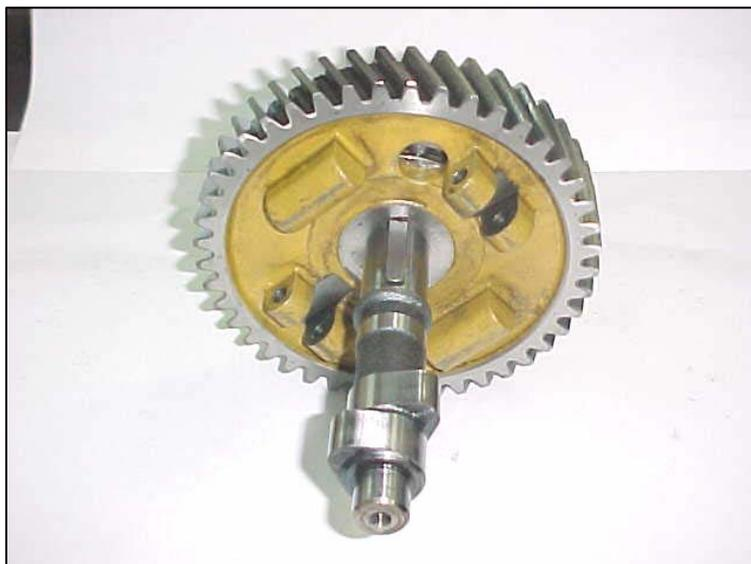
FIGURA 9 – Sistema utilizado nos testes, após a retirada dos contrapesos.
