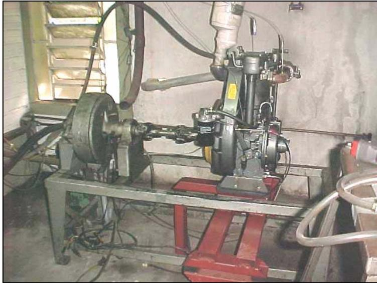
FIGURA 13 – Motor de teste na bancada dinamométrica.
