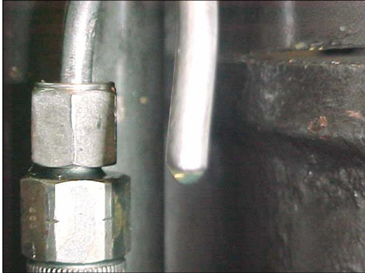
FIGURA 6 – Sifão instalado na saída da bomba injetora para determinação do avanço da injeção – início do débito.
