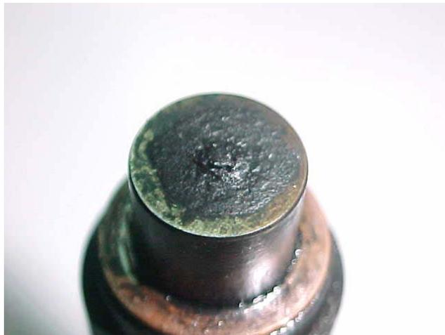
FIGURA 51 – Aspecto do injetor após 150 horas de funcionamento.
