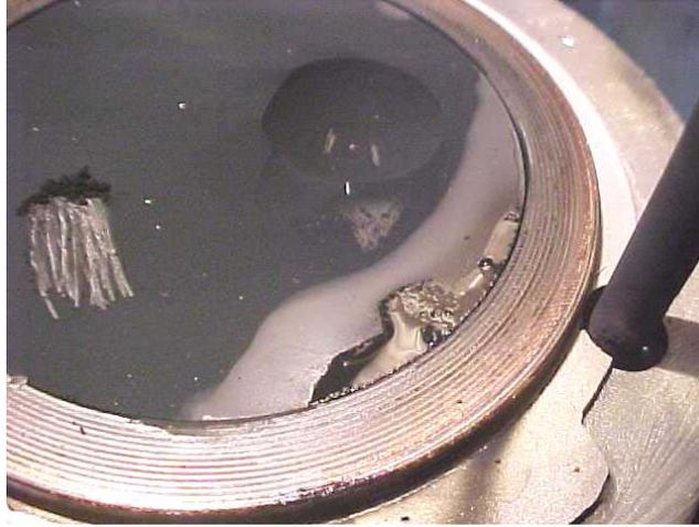
FIGURA 49 – Aspecto do topo do pistão após 150 horas de funcionamento.
