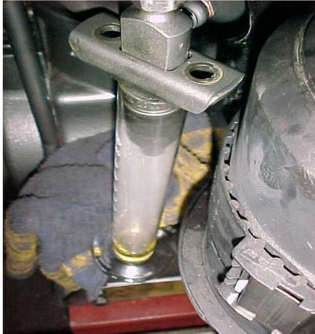
FIGURA 16 – Avaliação do consumo específico de combustível - Método do número de ciclos de injeção.
