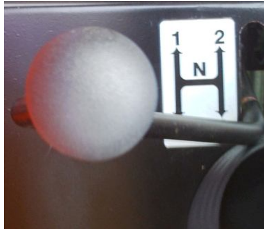
Figura 7 – Alavanca de marchas sem identificação quanto à função que desempenha.
