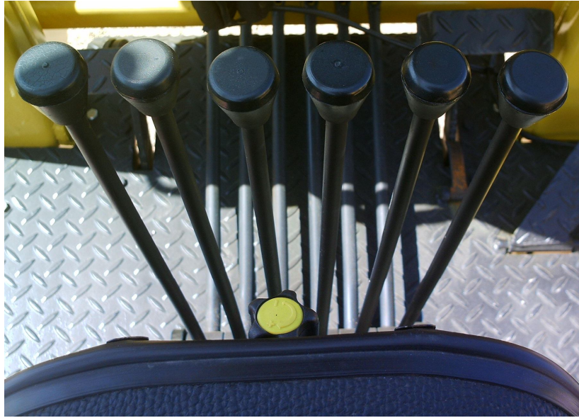
Figura 9 – Controles de operação sem identificação da função que executam.
