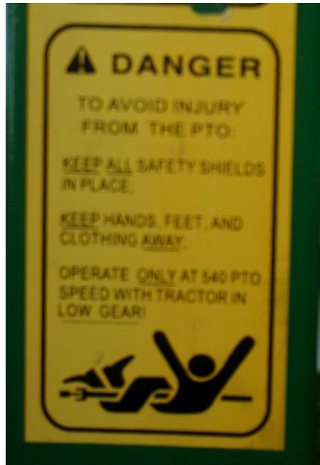
Figura 25 – Simbologia gráfica conforme a ISO 11684 (1990), porém instruções em inglês.
