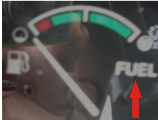
Figura 13 – Marcador de combustível inadequado, com indicação em língua estrangeira.
