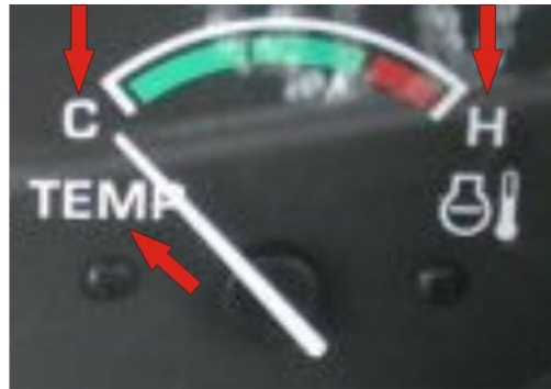
Figura 16 – Indicador da temperatura do líquido de arrefecimento inadequado.
