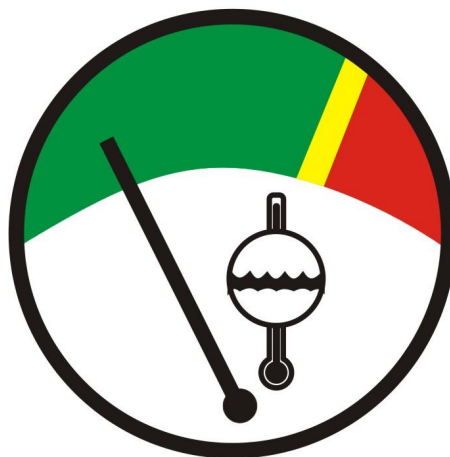
Figura 15 – Marcador de temperatura do líquido de arrefecimento do motor indicado pela NBR 11379 (1990).
