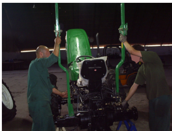
Figura 4.9 – Instalação do E.P.C.C.
