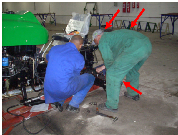
Figura 4.7 - Instalação do eixo traseiro.
