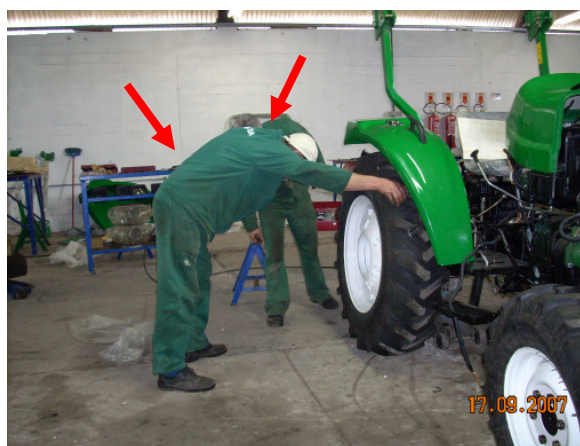
Figura 4.8 – Instalação da roda traseira.
