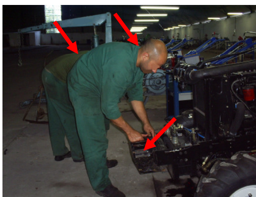
Figura 4.10 – Colocação dos lastros dianteiros.
