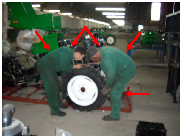
Figura 4.6 - Instalação da roda dianteira.
