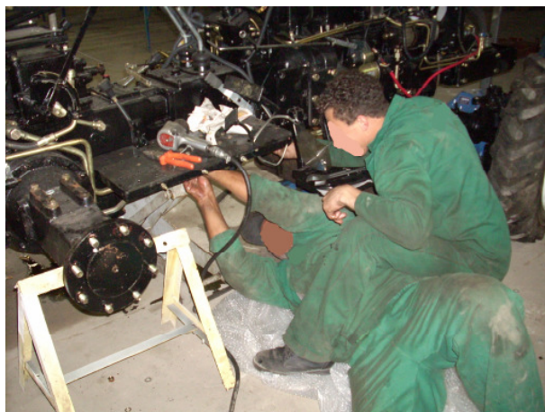
Figura 4.2 – Instalação do eixo cardã.
