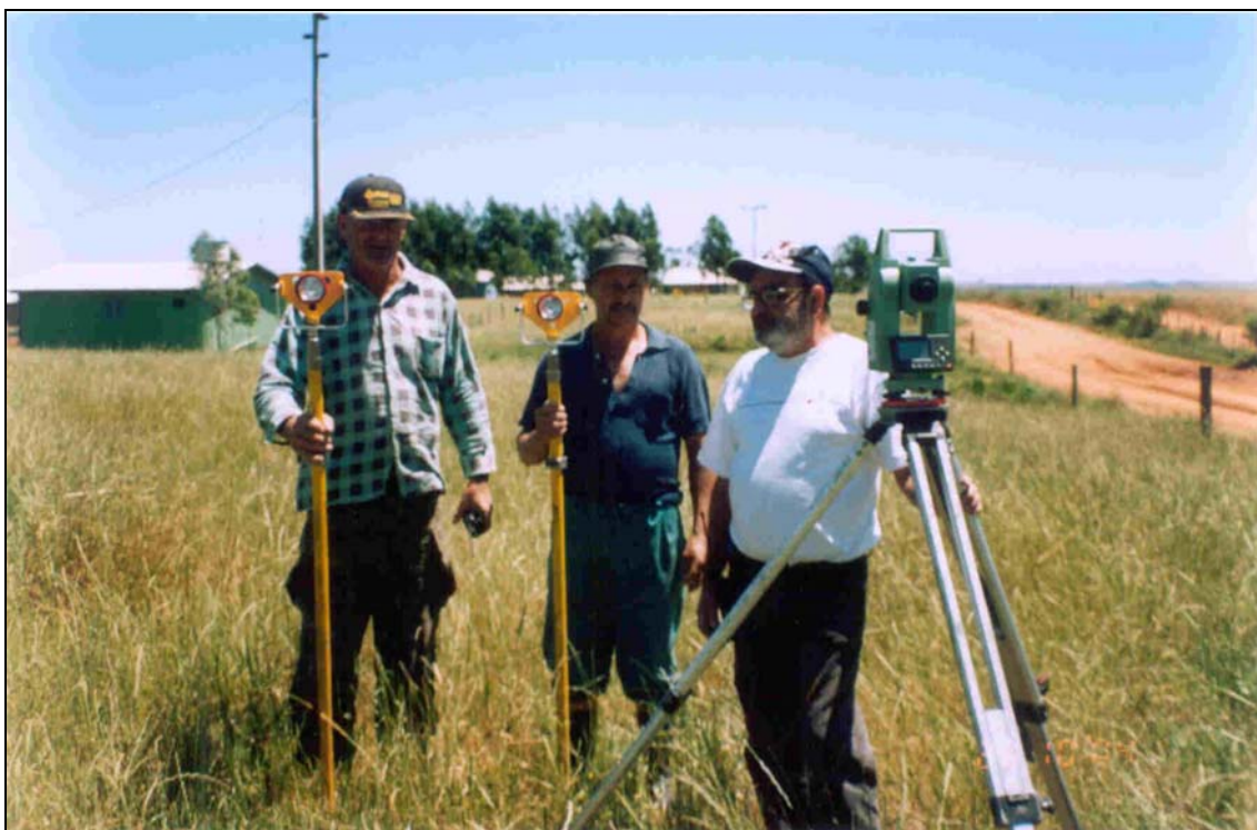
FIGURA 10. Estação total e prismas utilizados no levantamento do polígono teste
