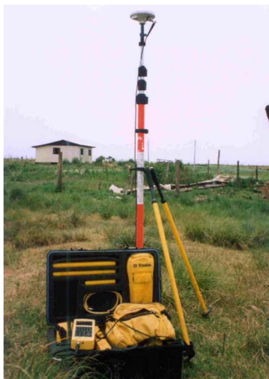
FIGURA 13. Receptor GPS instalado no ponto do polígono teste.
