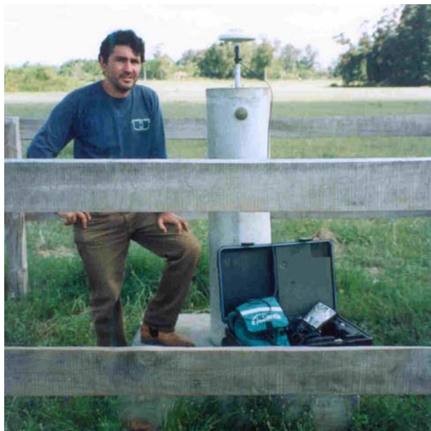
FIGURA 12. Receptor GPS instalado na estação base. Marco nº 92.024
