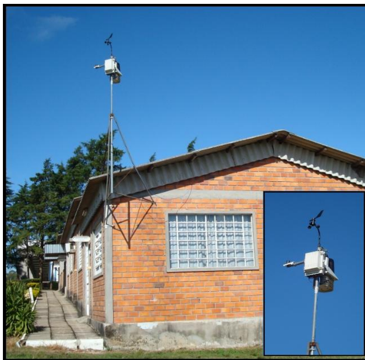
Figura 04 - Estação climatológica automática. Santiago, RS, 2008.
