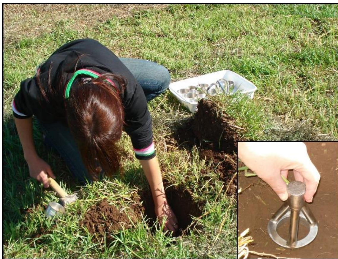
Figura 02 - Abertura da trincheira para coleta de amostras para determinação das características físicas do solo com detalhe do coletor de amostras. Santiago, RS, 2007.
