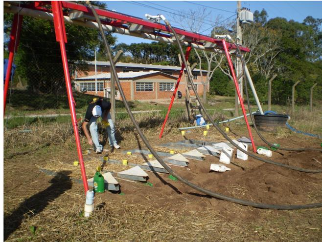
**Figura 2 - Detalhe do simulador de chuva estacionário de bicos múltiplos e oscilantes utilizado nas aplicações das chuvas simuladas. Santa Maria, RS.2010.**
