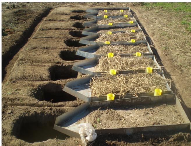
**Figura 1 - Detalhe das parcelas, calhas coletoras e pluviômetros utilizados nas avaliações das chuvas simuladas. Santa Maria, RS, 2010.**
