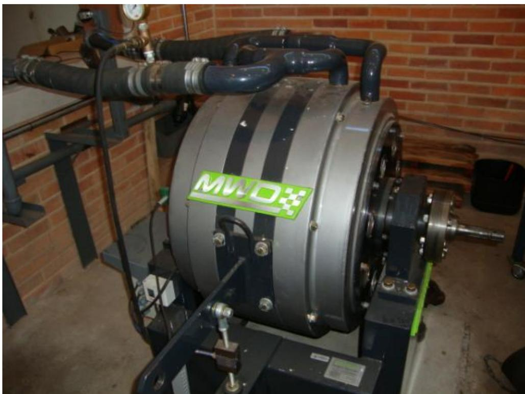
Figura 4- Dinamômetro de correntes parasitas utilizado nos ensaios.
