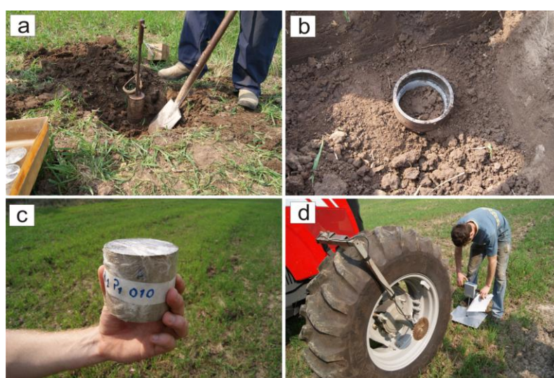
Figura 9 - Coleta de amostras para determinação das análises físicas de solo destrutiva e não destrutiva (a), copo coletor de análises não destrutivas (b); anel com amostra não destrutiva (c); coleta de dados de penetrometria (d)
