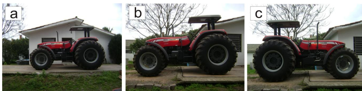
Figura 13 - Pesagem do trator teste: a) peso total; b) peso do eixo traseiro; c) peso do eixo dianteiro
