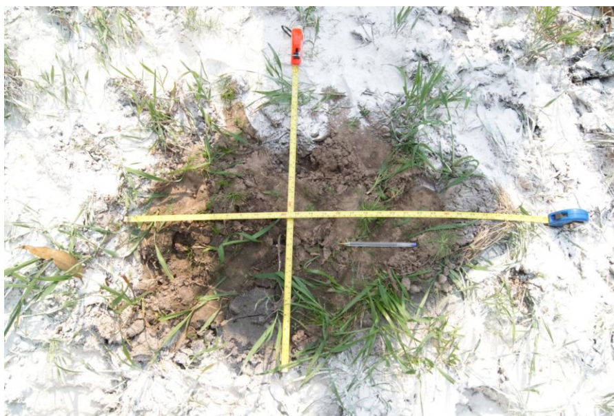
Figura 15 - Área de contato pneu-solo e trenas para verificação das medidas formadas pela largura e comprimento da elipse para posterior cálculo da área de contato
