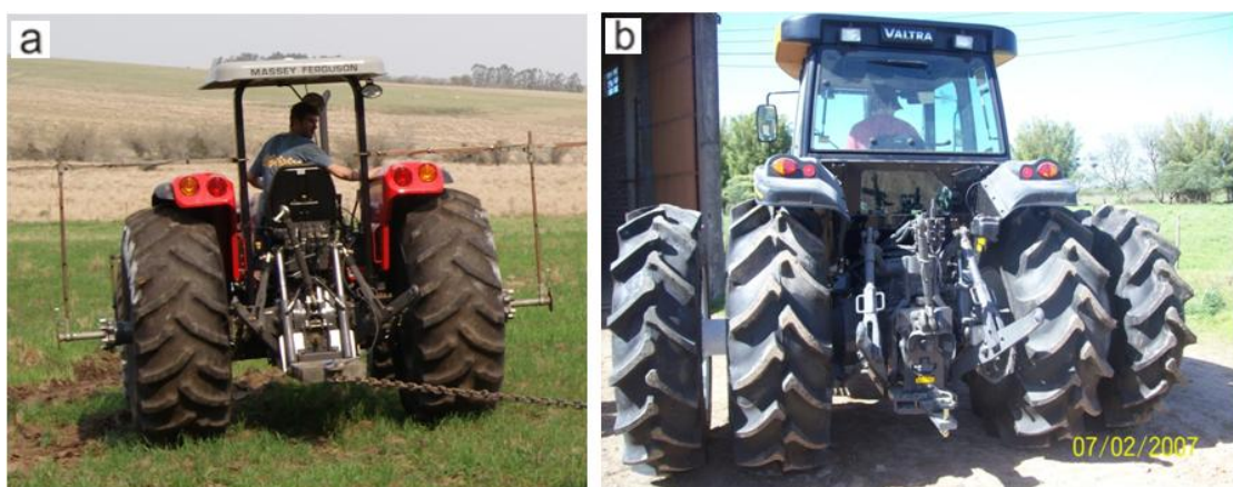
Figura 3 - Trator equipado com rodado simples e pneus do tipo R1 no eixo traseiro (a) e trator com rodado duplo e pneus do tipo R2 no eixo traseiro
