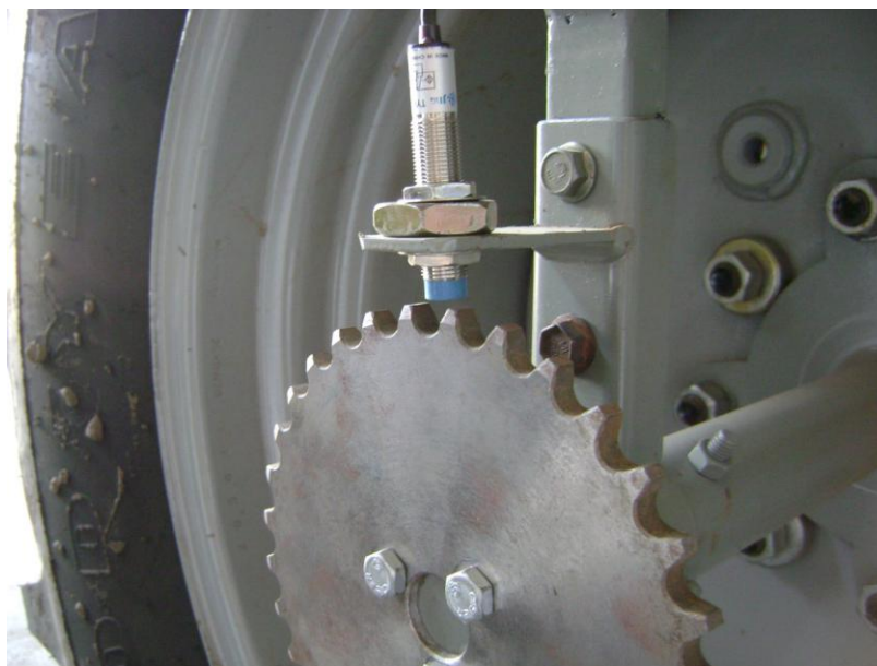
Figura 20 – Detalhe da roda dentada e sensor do tipo indutivo
