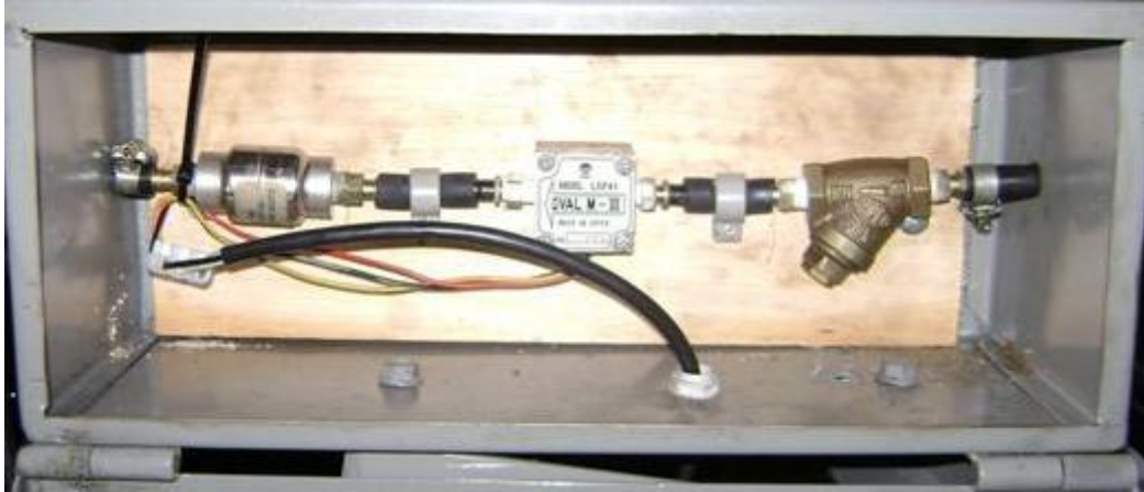
Figura 30 - Medidor de fluxo utilizado na determinação do consumo horário de combustível
