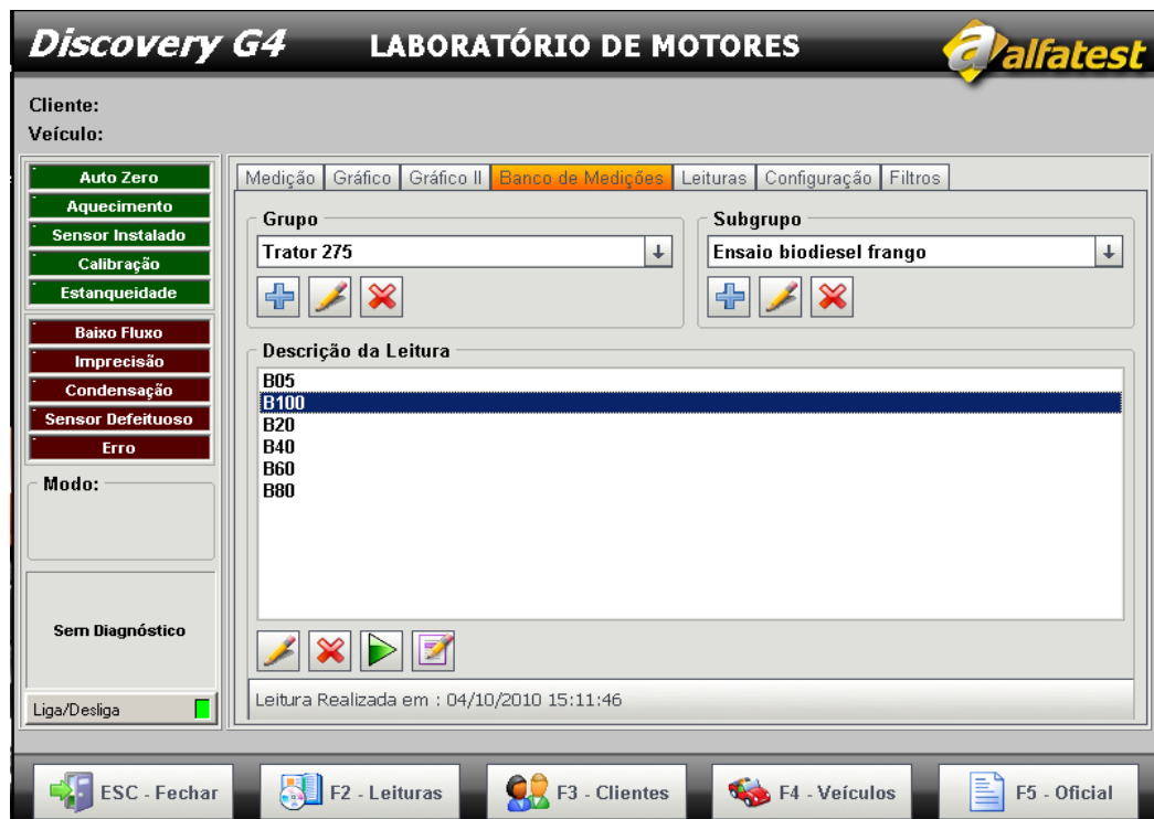
Figura 33 - Interface gráfica do software Discovery G4, utilizado para fornecimento e controle dos dados dos gases captados na exaustão
