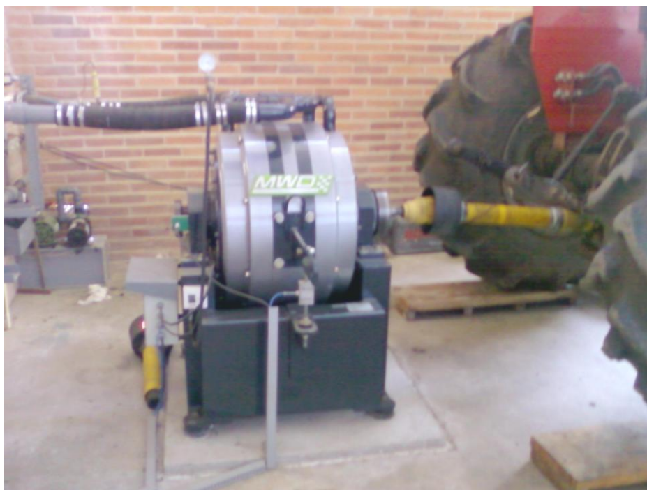
Figura 28 - Dinamômetro NL 480, com visualização do sistema de refrigeração e acoplamento do trator utilizado por árvore cardã
