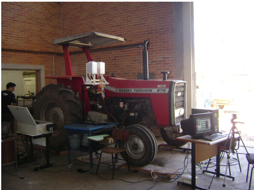
Figura 26 - Trator MF 275 submetido aos ensaios de dinamometria e emissões
