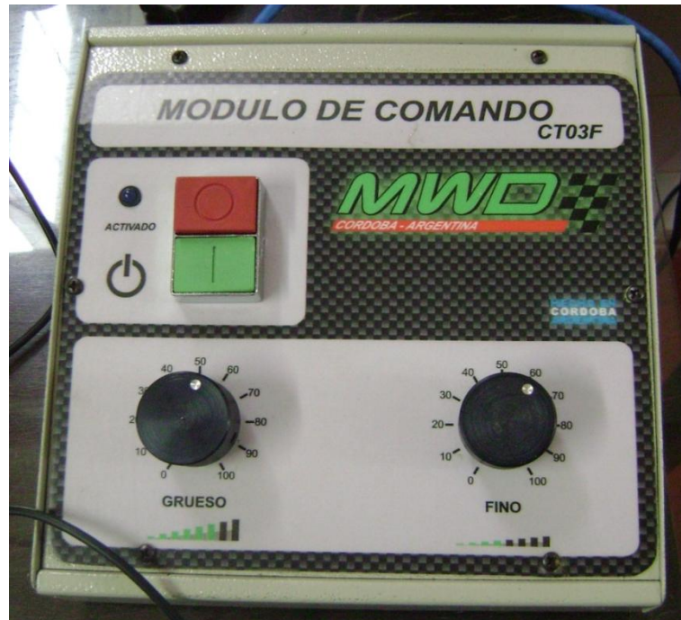
Figura 35 - Módulo de comando CT03F, para controle manual de carga/frenagem
