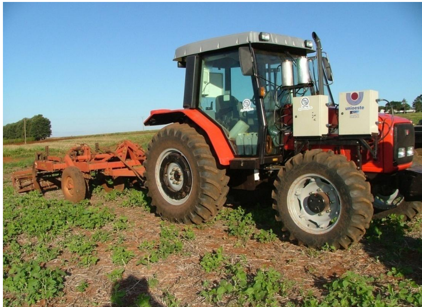
Figura 25 - Trator instrumentado e ensaiado por Silva (2006), com tanques auxiliares para uso e substituição rápida de diferentes proporções de diesel e biodiesel
