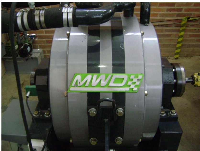
Figura 27 - Visualização lateral do dinamômetro MWD NL 480 utilizado nos ensaios
