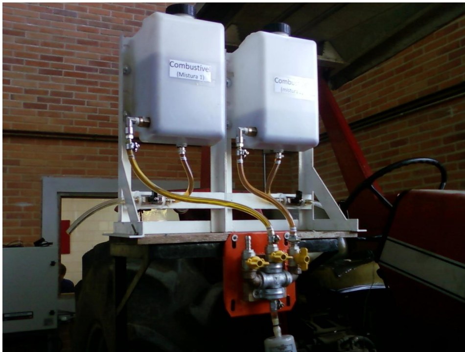
Figura 31 - Imagem dos dois tanques auxiliares utilizados
