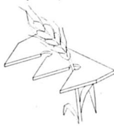
Figura 16 – Detalhes dos dentes destacadores de uma plataforma recolhadora de grãos
