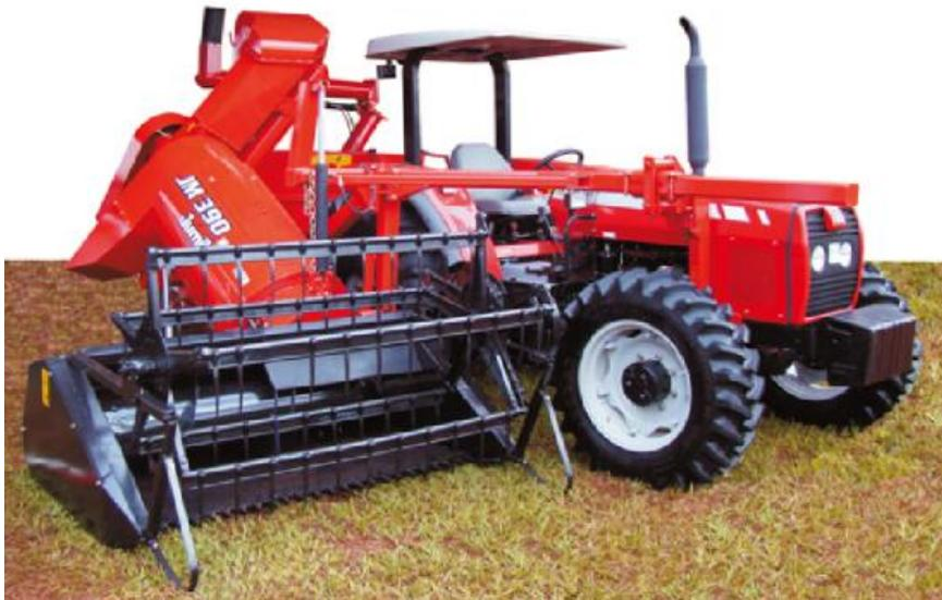
Figura 11 – Colhedora combinada acionada pela tomada de potência do trator
