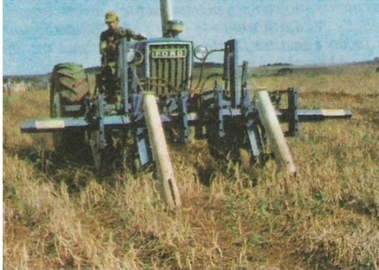
Figura 8 – Arrancador CEMAG em operação
