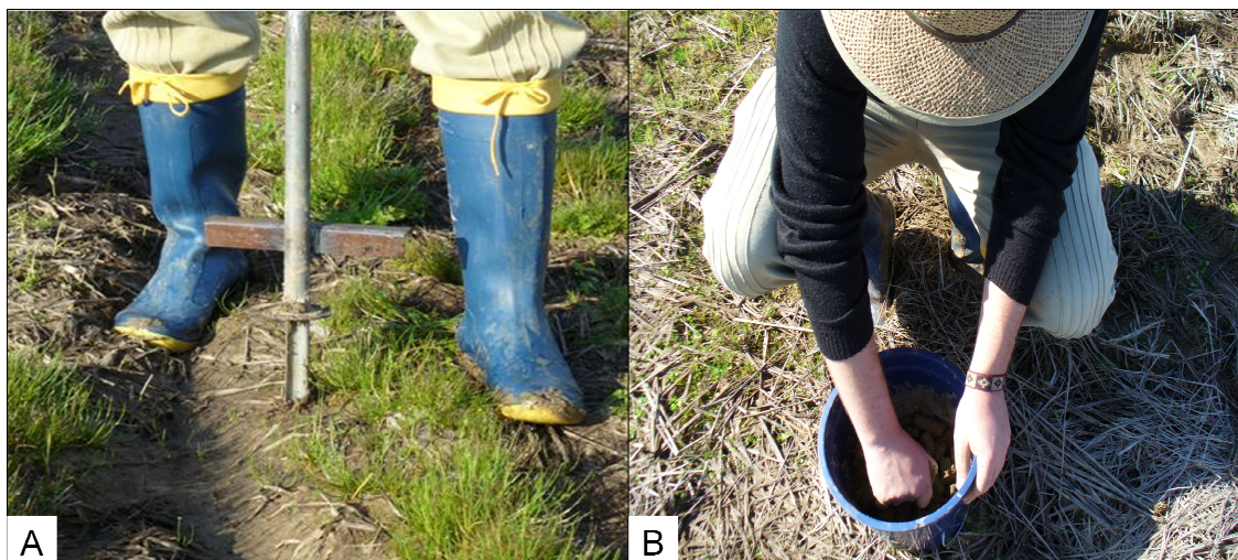
Figura 13 – Amostragem com trado calador (A) e homogeneização da amostra (B).
