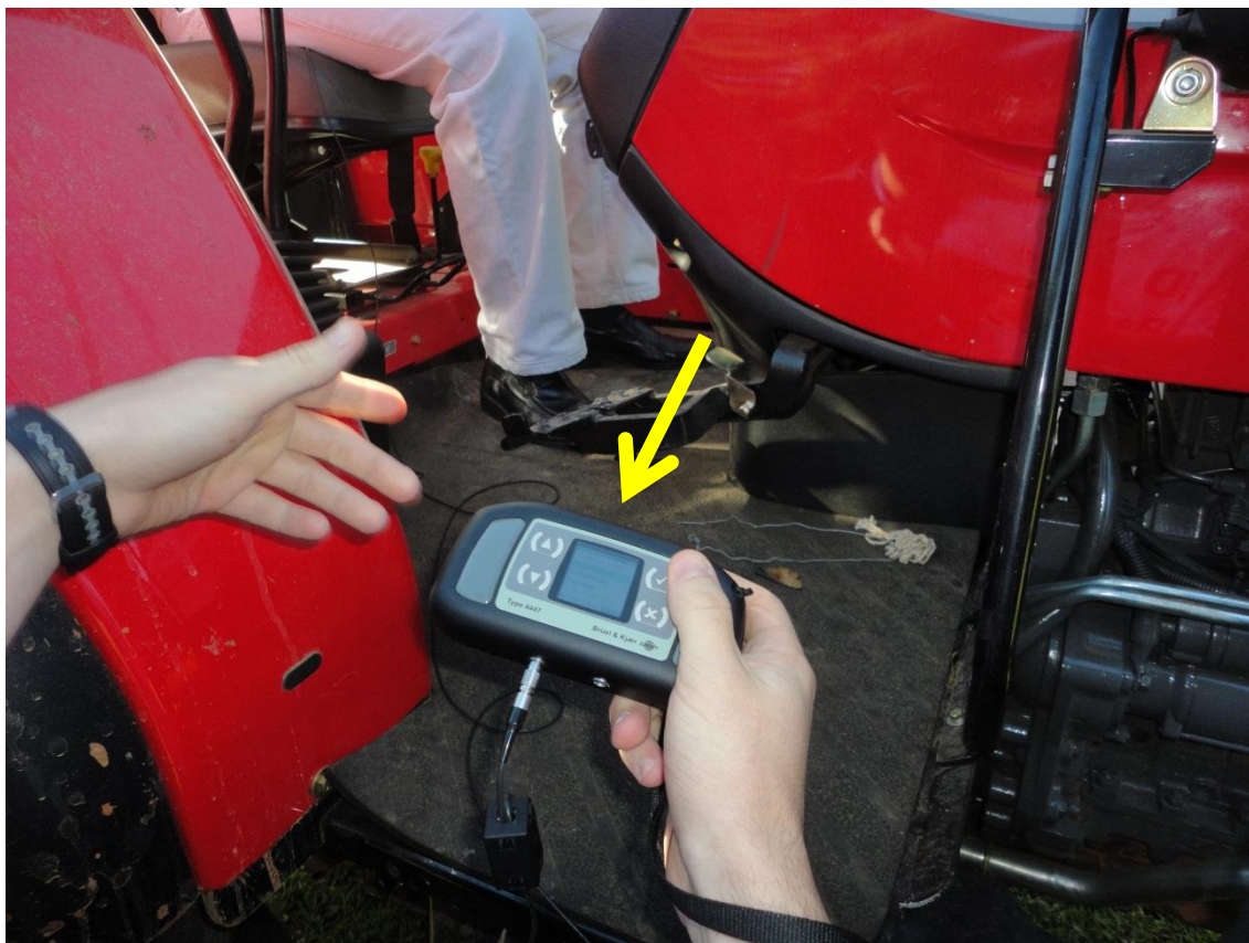
Figura 23 – Analisador de Vibrações no Corpo Humano, modelo 4447, da Brüel & Kjær.
