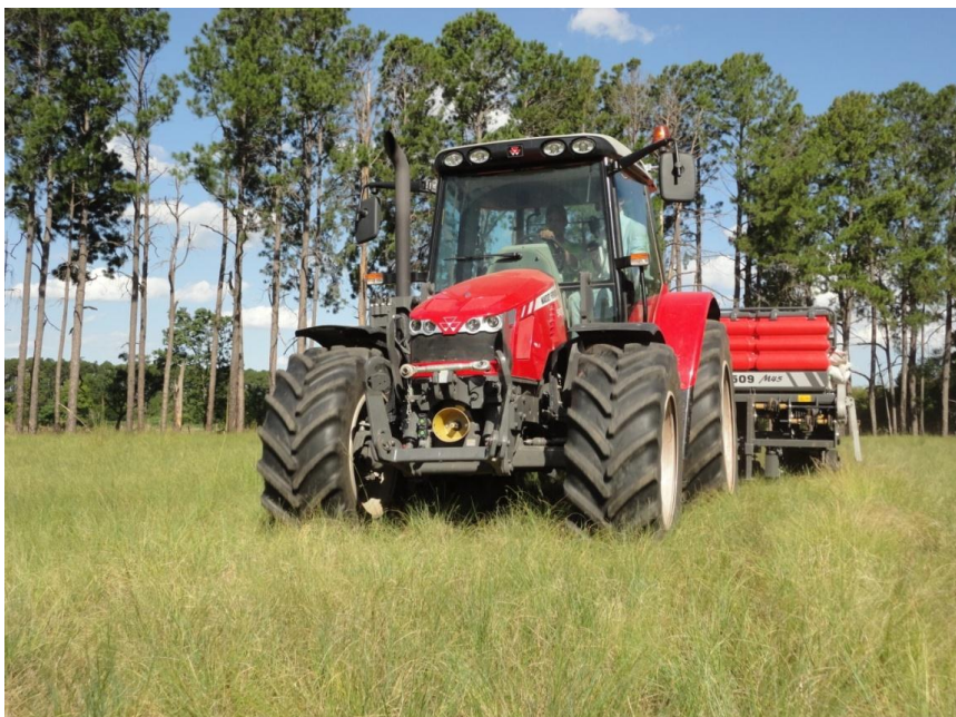
Figura 28 – Trator configurado com pneus radiais em operação no momento de uma das medições realizadas.
