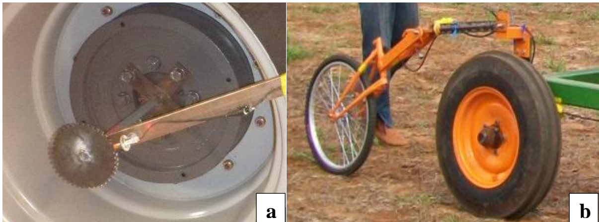
Figura 8 - Suporte para o sensor indutivo da roda motriz (a) e a roda odométrica acoplada atrás da estrutura porta-ferramentas (b).
