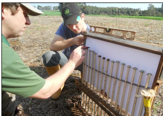
Figura 11 - Demarcação do relevo original do solo em local pré-definido, com o auxílio de um perfilômetro de hastes.
