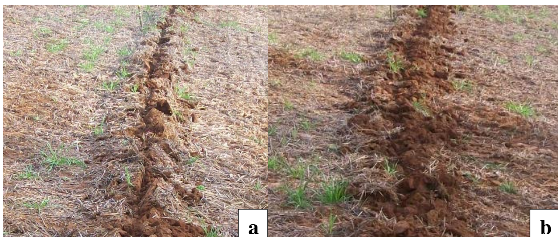
Figura 14 – Aspecto visual da área de elevação do solo de um mesmo elemento descompactador com disco de corte a 2,98 \text{Km h}^{-1} (a) e a 5,80 \text{Km h}^{-1} (b).
