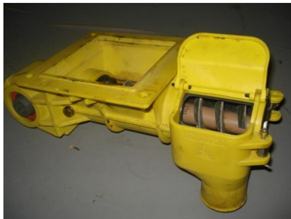
Figura 3.3.3 – Dosador 3: Tipo sem-fim, transportador helicoidal, com descarga de fertilizante lateral. Fonte: Autor.
