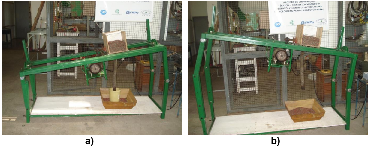
Figura 3.7.1 – a) Bancada na posição 11° para esquerda; b) bancada na posição 11° para direita. Fonte: Autor.
