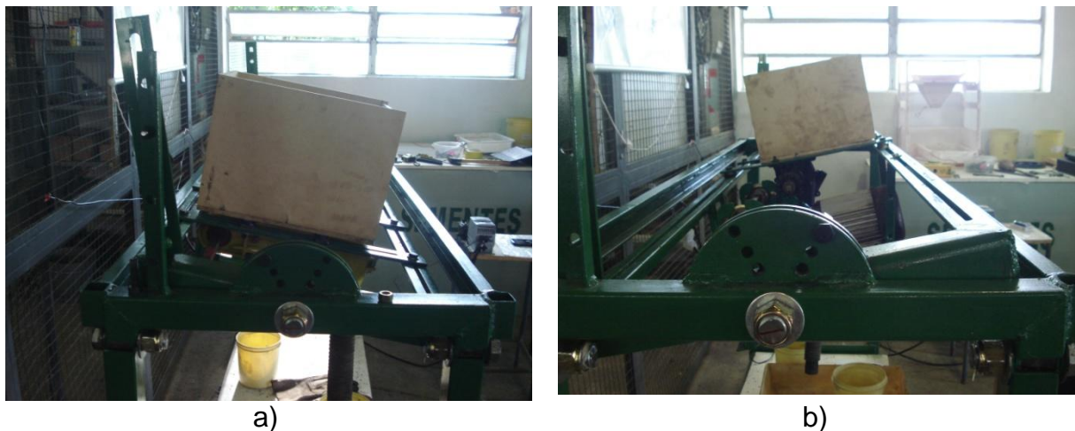
Figura 3.6.1 – a) Bancada na posição 11^\circ no sentido ascendente; b) Bancada na posição 11^\circ no sentido descendente. Fonte: Autor.
