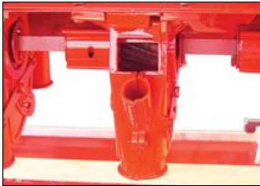
Figura 2.2.3 - Dosador de fertilizantes rotor acanalado. Fonte: Jumil, Catálogo de produtos, 2010.
