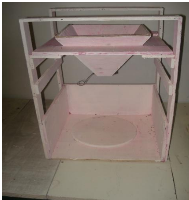
Figura 3.4.1 – Dispositivo para determinação de ângulo de repouso dos fertilizantes. Fonte: Autor.
