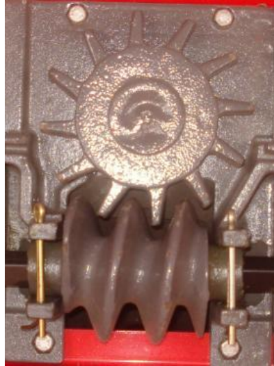
Figura 3.3.5 – Dosador 5: Tipo disco estrela. Fonte: Autor.
