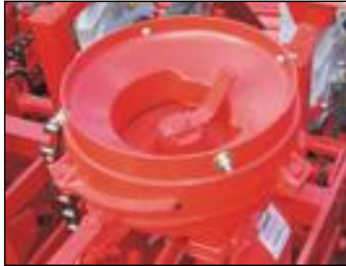
Figura 2.2.4 - Dosador de fertilizantes disco horizontal giratório. Fonte: Jumil – Catálogo de produtos, JM J2 S, 2011.
