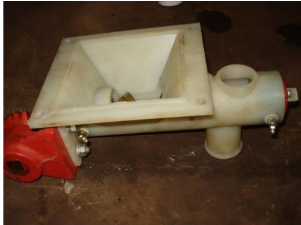
Figura 3.3.2 – Dosador 2: Tipo sem-fim, transportador helicoidal, com descarga de fertilizantes por gravidade. Fonte: Autor.
