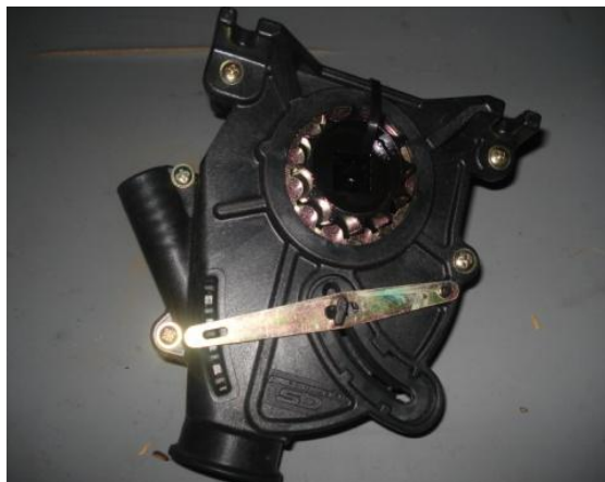
Figura 3.3.4 – Dosador 4: Tipo rotor acanalado. Fonte: Autor.
