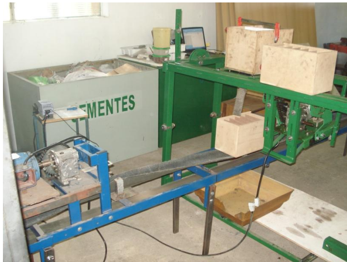
Figura 3.5.2 – Esteira utilizada para simulação do deslocamento da semeadora-adubadora. Fonte: Autor.
