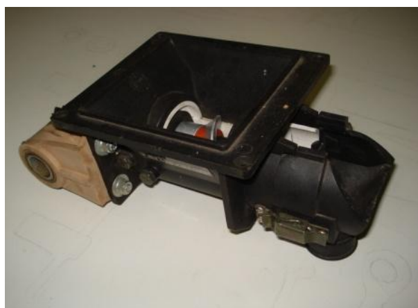
Figura 3.3.1 – Dosador 1: Tipo sem-fim, transportador helicoidal e descarga de fertilizantes por transbordo. Fonte: Autor.
