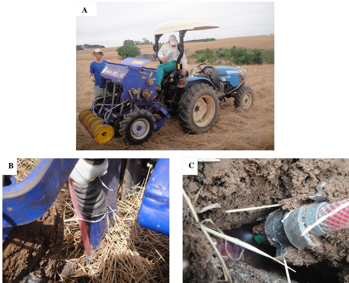
Figura 1 - Semeadora Imasa PHS 63 com sistema adaptado para aplicação de produtos líquidos no sulco de semeadura. Visão geral da semeadora acoplada ao trator Marca Landini, Modelo Montana 45 (A). Mangueira acoplada na haste sulcadora (B). Detalhe do jato de pulverização dentro do sulco de semeadura (C). Santa Maria, UFSM, 2012.
