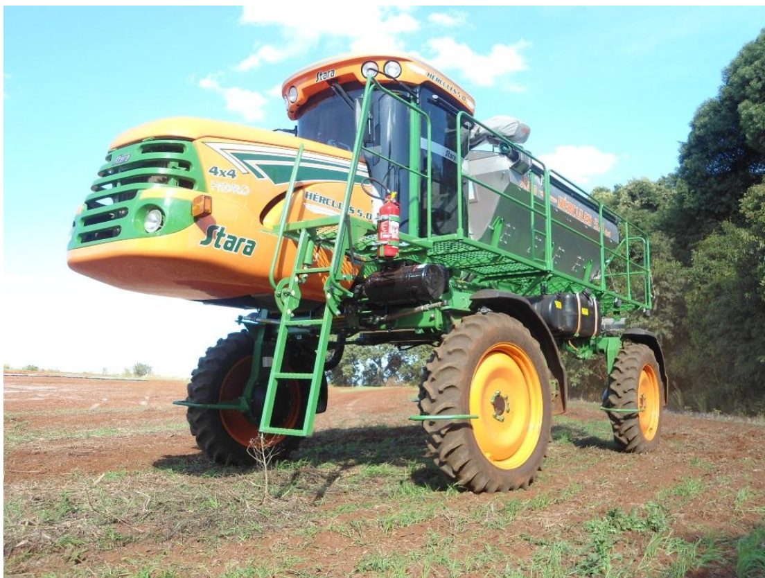
Figura 2 – Distribuidor centrífugo autopropelido utilizado nas avaliações.
