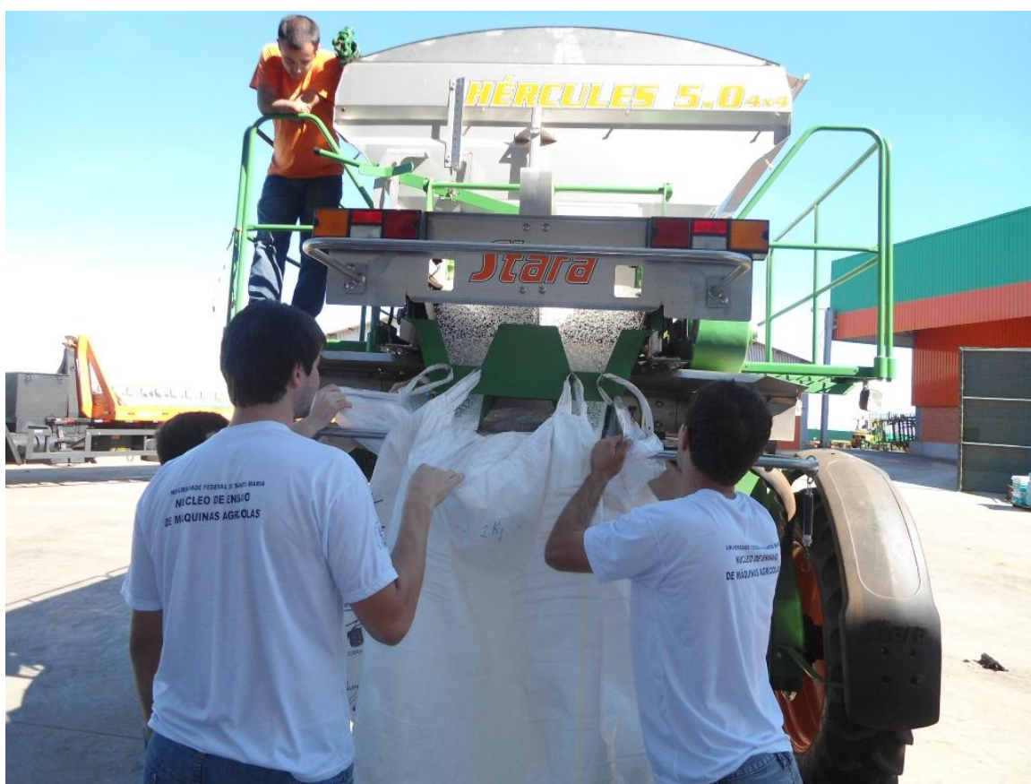
Figura 12 – Vista do distribuidor durante determinação da vazão.
