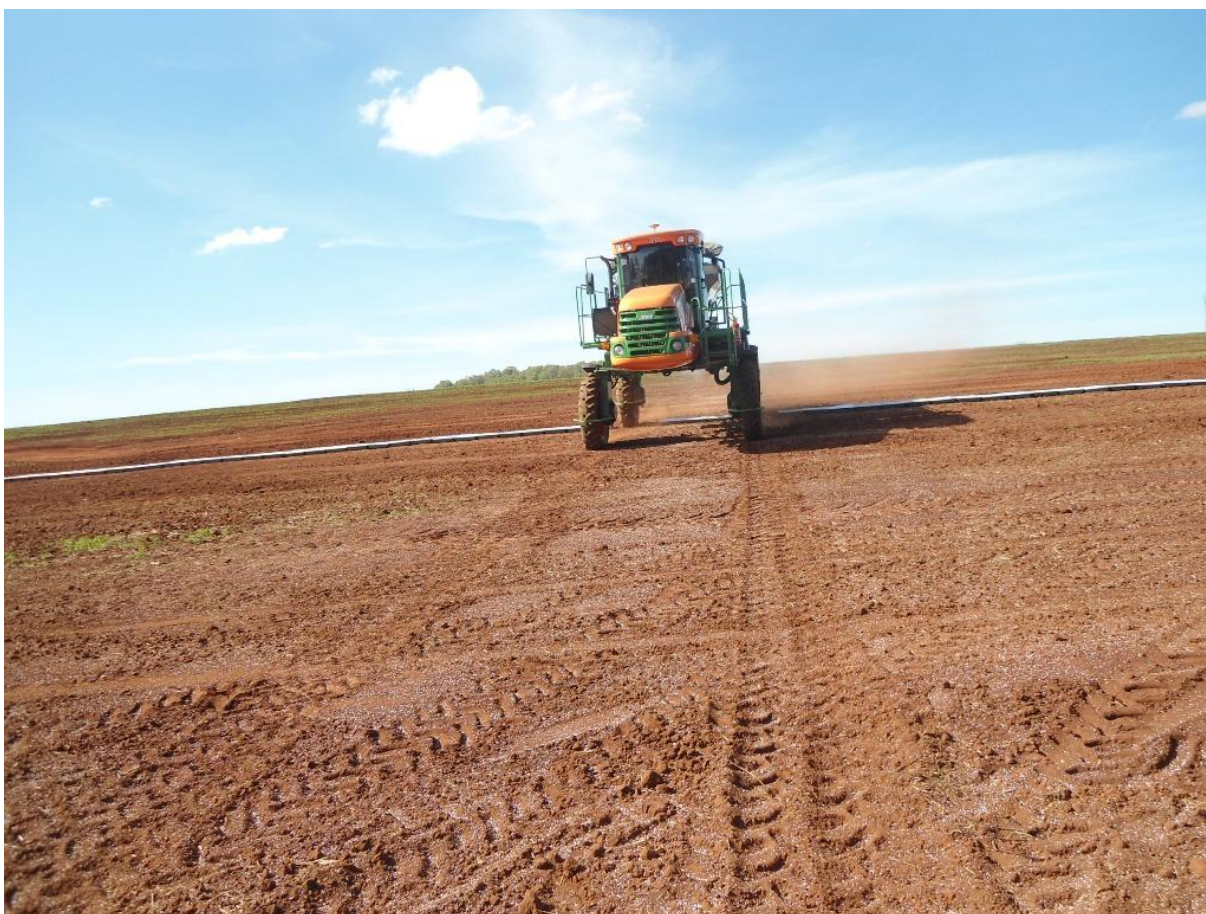
Figura 14 – Vista do distribuidor durante avaliação do perfil transversal.
