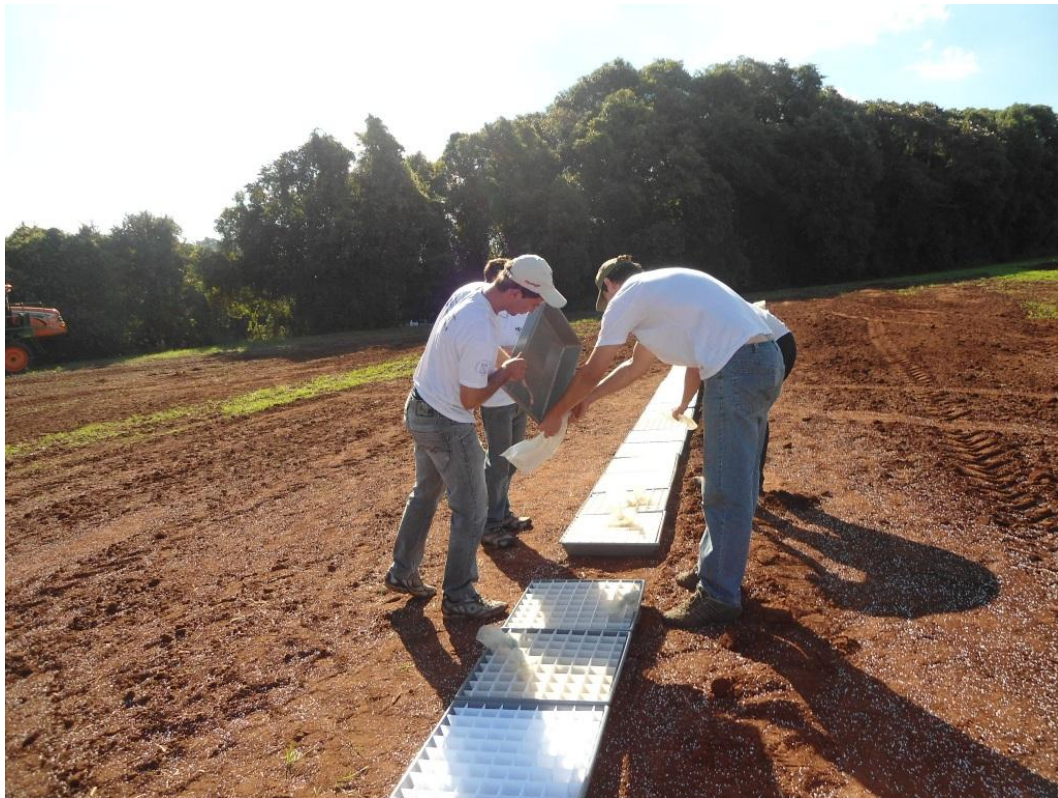
Figura 7 – Recolhimento do material após a passagem do distribuidor.
