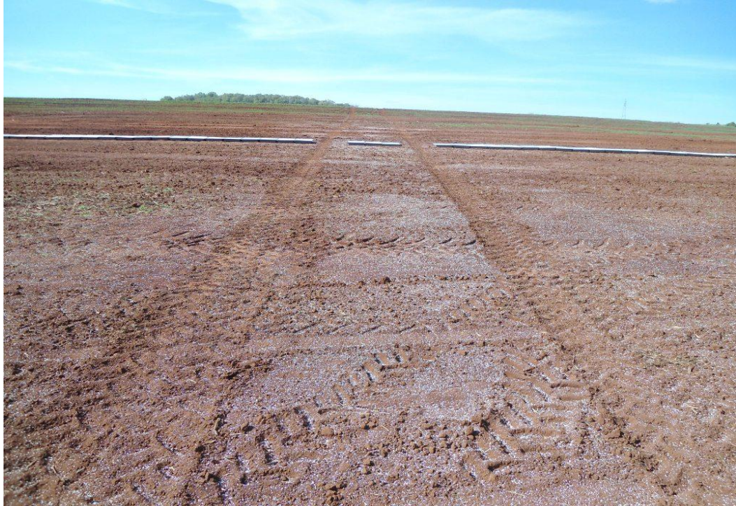
Figura 5 – Distribuição das bandejas coletoras para determinação do perfil transversal.
