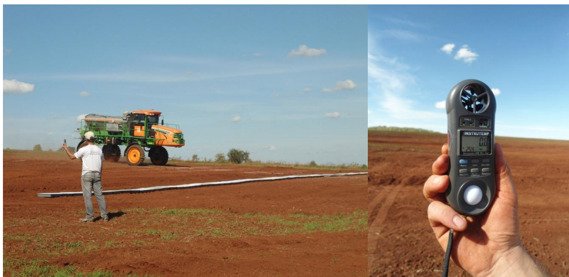
Figura 11 – Determinação da velocidade do vento durante as repetições.
