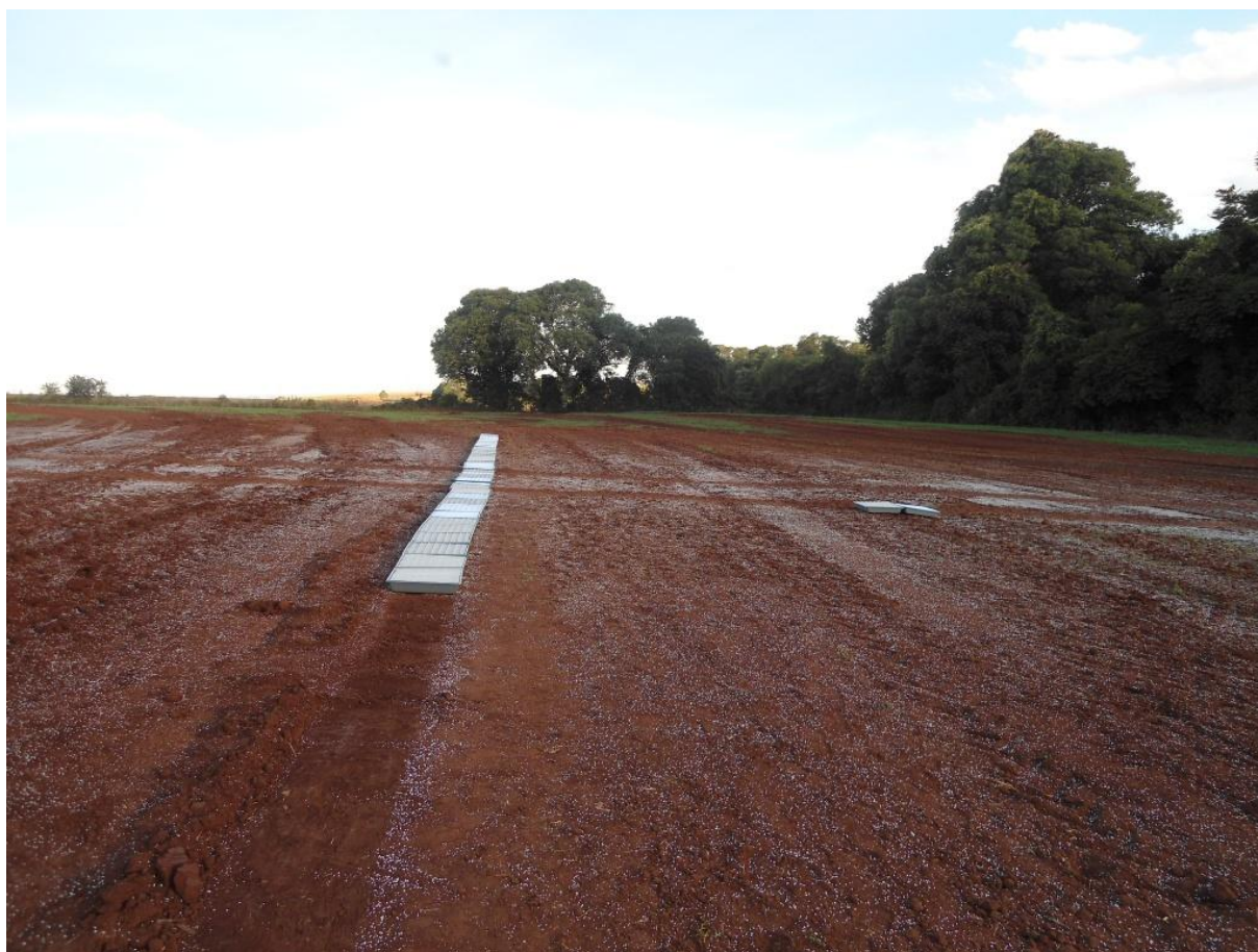
Figura 10 – Distribuição das bandejas coletoras para determinação do perfil longitudinal.
