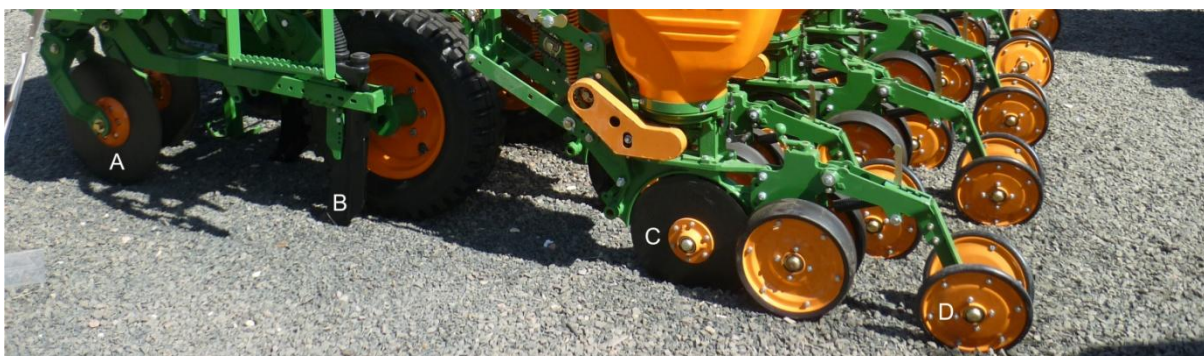
A - Disco de corte; B - Sulcador para deposição de adubo tipo haste; C - Sulcador para deposição de semente tipo disco duplo; D - Roda compactadora
