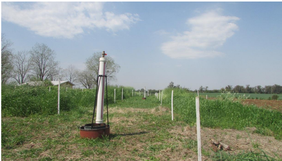
Figura 3 - Determinação da infiltração de água no solo com a utilização de anéis concêntricos.
