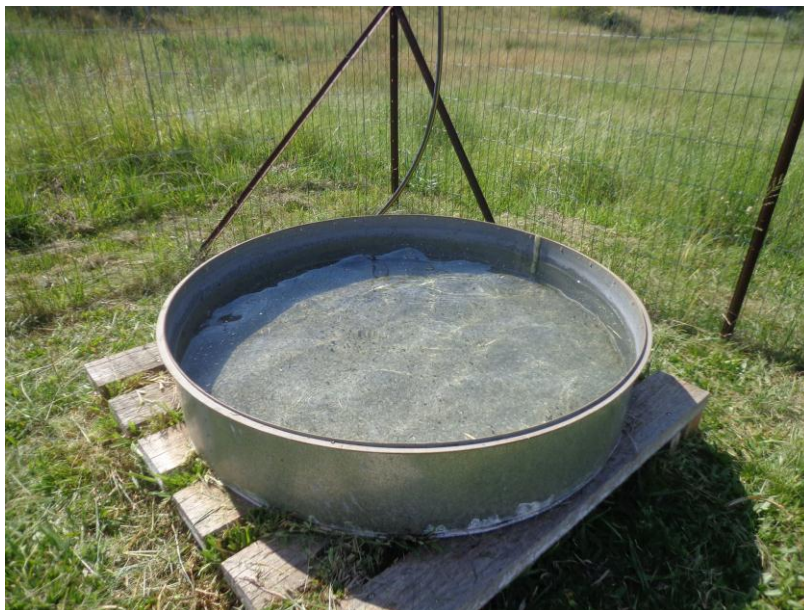
Figura 5 - Tanque Classe A.
