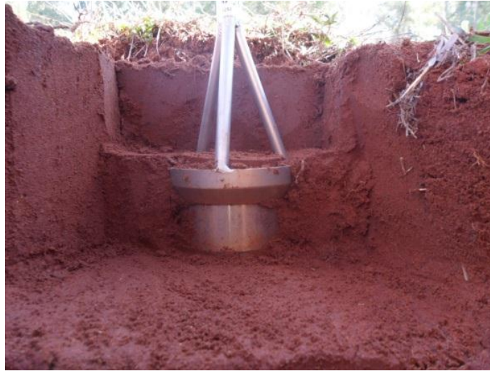
Figura 2 - Amostragem de solo da área experimental, coleta de amostra indeformada com cilindro mostrador.
