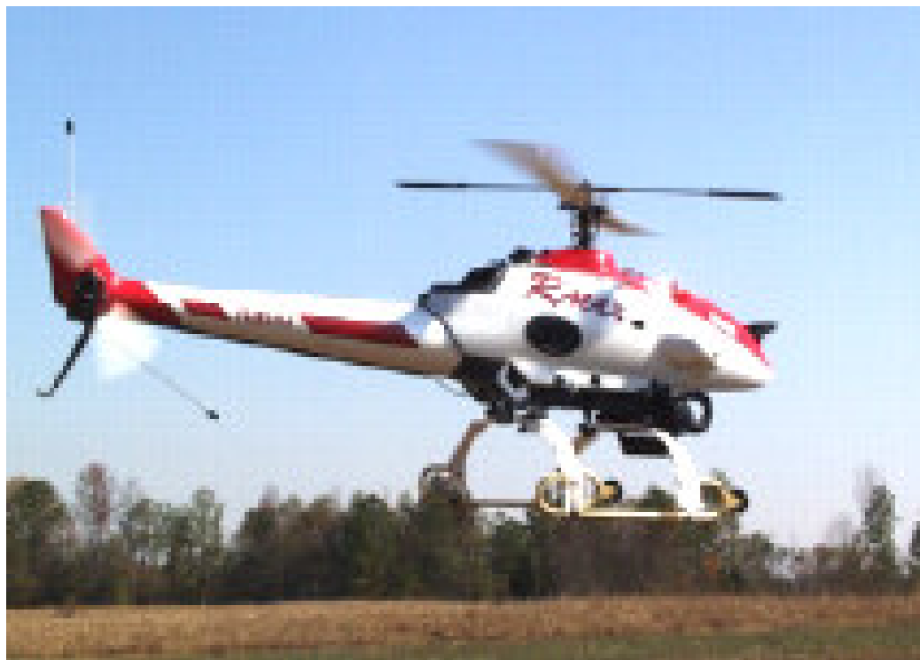
Figura 9 - Veículo aéreo não tripulado de decolagem e pouso vertical Fonte: Rmax, (2001)
