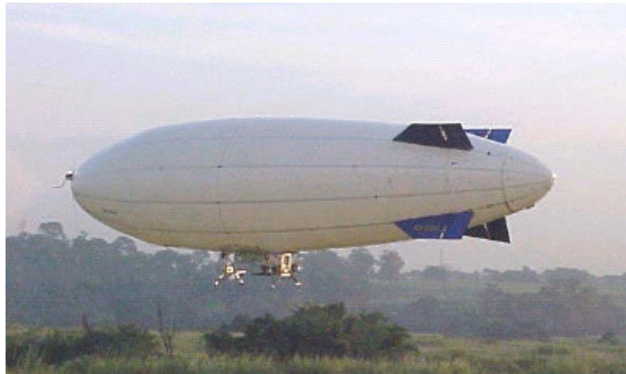
Figura 6 - Veículo aéreo não tripulado (Dirigível) Fonte: CenPRA, ( 2001)
