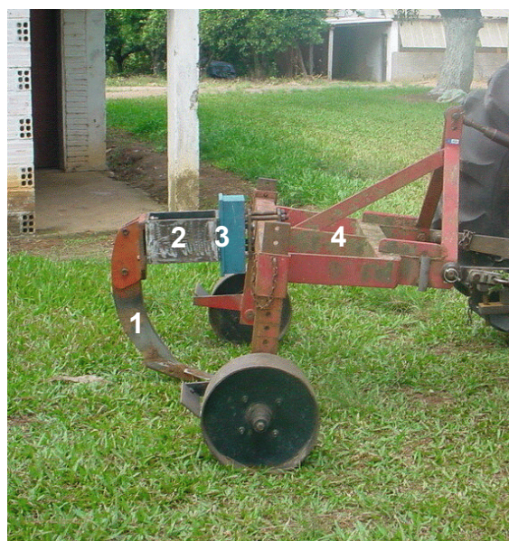
1 – haste escarificadora; 2 – suporte de acoplamento da haste; 3 – anel octogonal; 4 – estrutura porta ferramenta.
