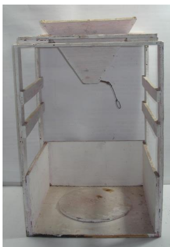
Figura 11 - Dispositivo utilizado para determinação do ângulo de repouso dos fertilizantes.
