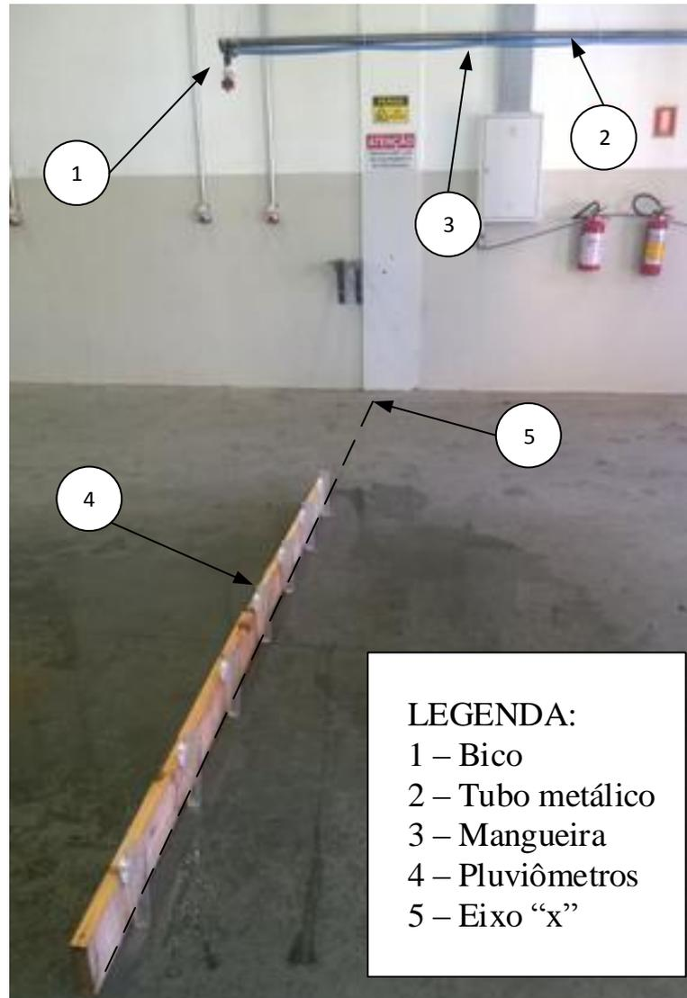
Figura 43 – Leiaute do experimento para verificar o perfil de distribuição e uniformidade de um bico
