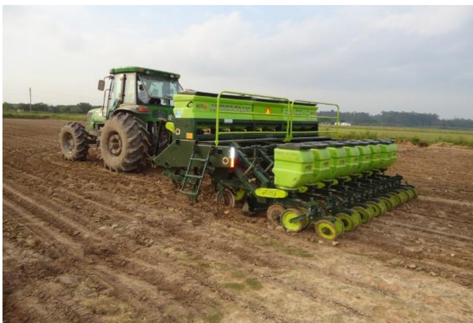
Figura 5 – Microcamalhoneira semeadora-adubadora utilizada na semeadura do experimento em Cachoeirinha, RS, no ano agrícola 2014/2015.
