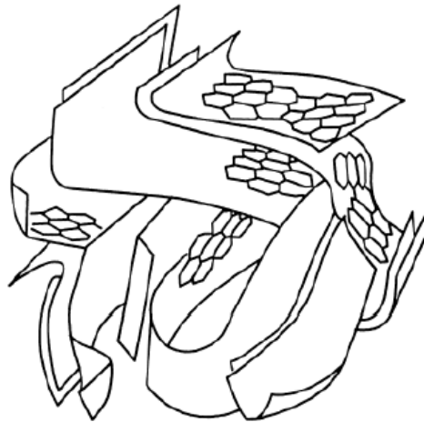
Figura 7 – Esquema da microestrutura de um carvão ativado
