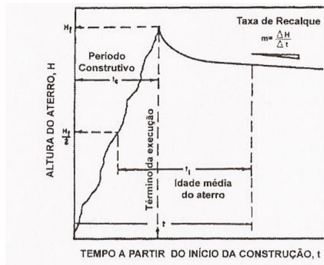
Figura 2.6 – Definição da idade média do aterro ( t_1 ). Fonte: MARQUES, 2001.
