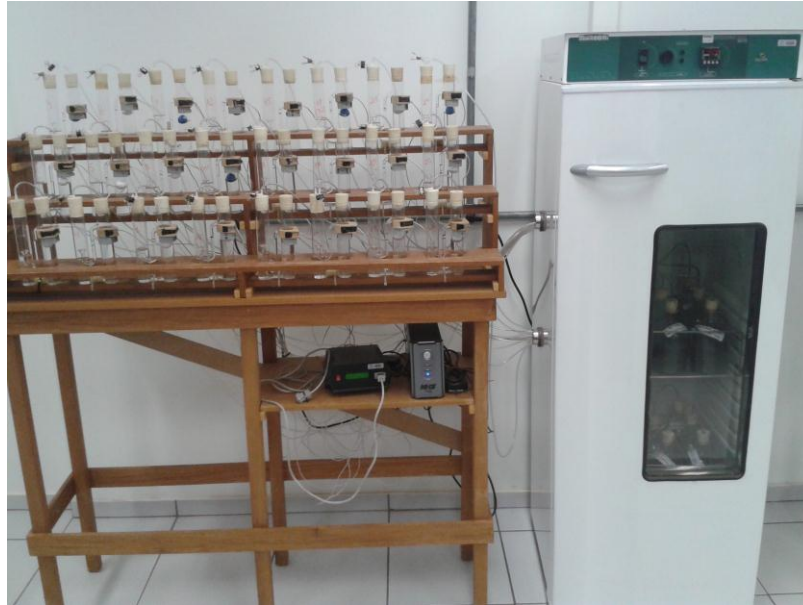
Figura 9 – Estufa e sistema de medição do biogás
