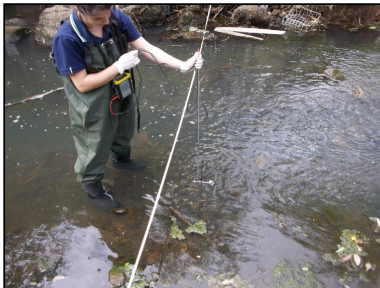
Figura 15 – Medição com o micromolinetete marca A-OTT, Hélice 3
