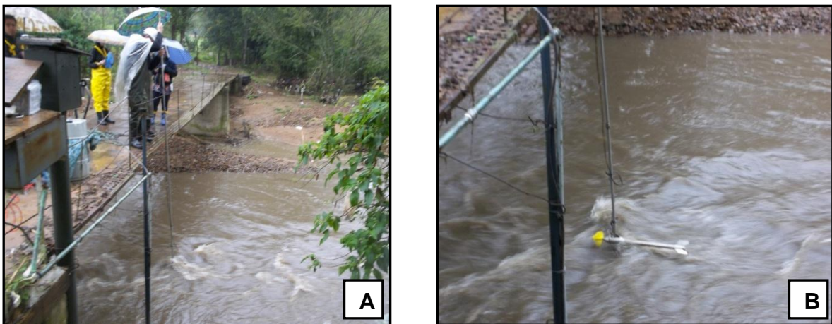
Figura 14 – Medição com o molinete fluviométrico marca HC, n. 128.000 (A), vista aproximada do molinete fluviométrico no campo (B)
