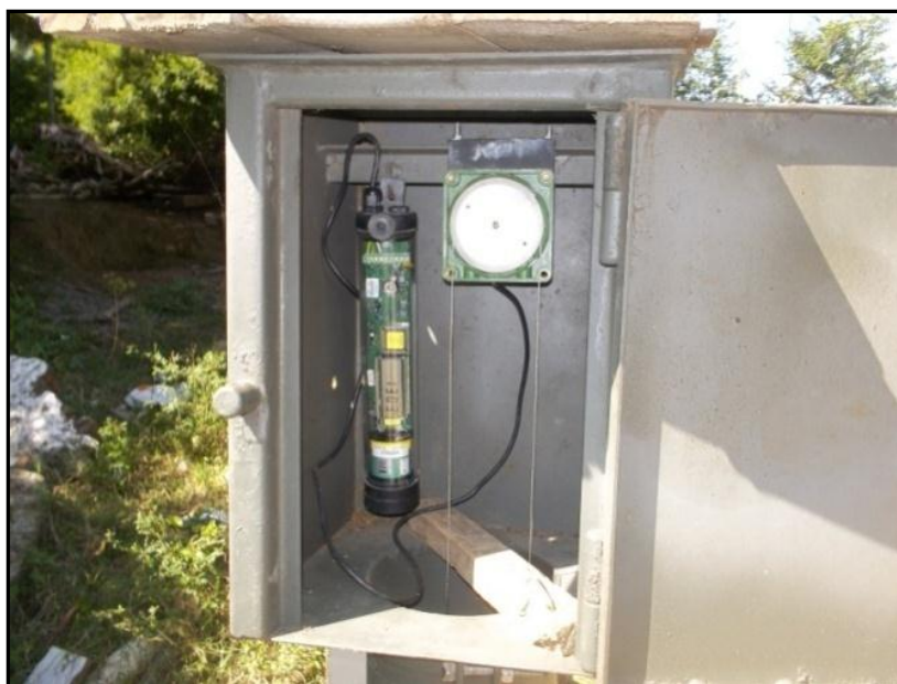
Figura 13 – Linígrafo digital, de bóia, com datalogger
