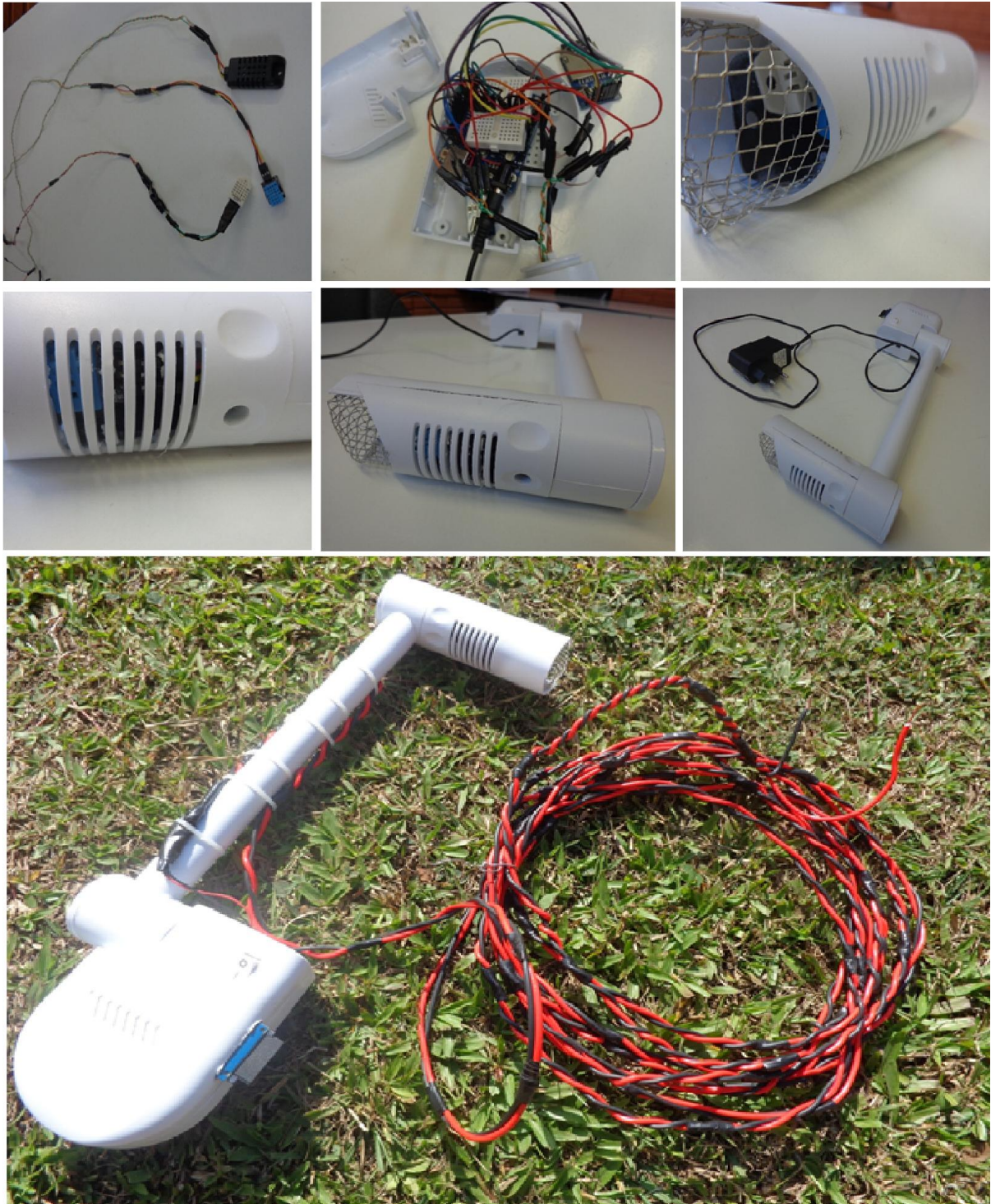
Figura 27 - Processo de montagem do circuito eletrônico no abrigo.
